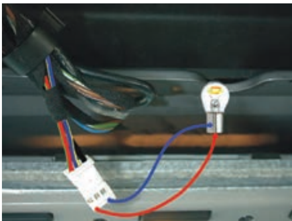
شکل ۱-۲۳۷- آزمایش سیم کشی مدار چراغ فندک
