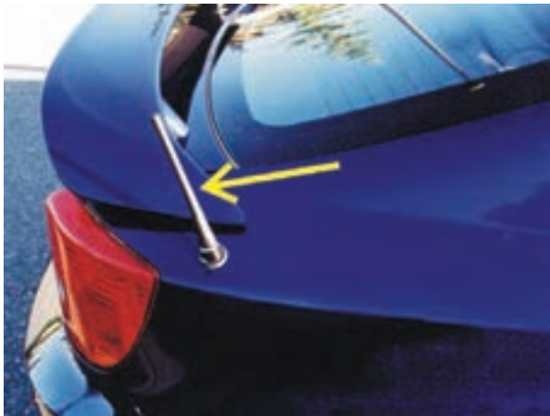
شکل ۱۶-۵- باز شدن میله‌ی آنتن
