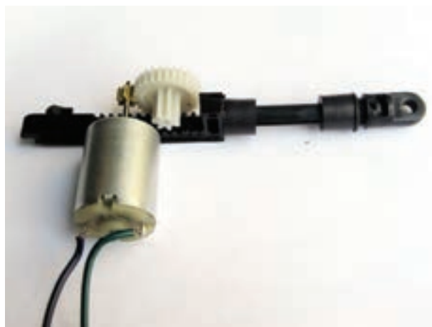
شکل ۲۰-۲- نحوه‌ی ارتباط چرخ‌دنده‌ها هنگام تبدیل دور
