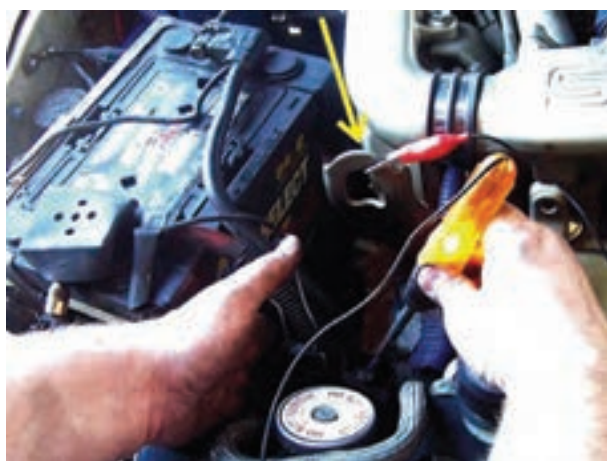
شکل ۴۳-۵- نحوه‌ی آزمایش سالم بودن سیم‌کشی
