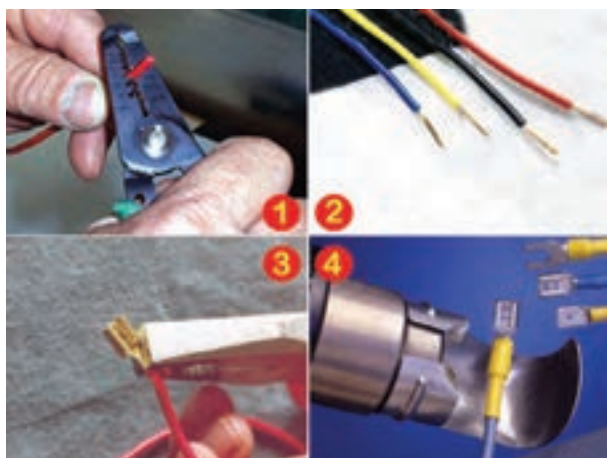
شکل ۴۷-۵- آماده کردن سیم‌ها برای سیم‌کشی
