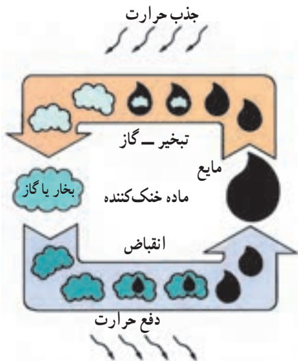
شکل ۵-۳- مراحل تغییر ماده خنک‌کننده
