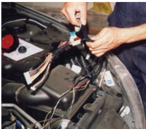
شکل ۲-۷۷ - نحوه‌ی عایق‌بندی سیم‌های مدار الکتریکی دزدگیر
