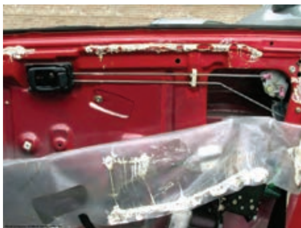
شکل ۲-۲۶- جدا کردن پلاستیک محافظ روی در
