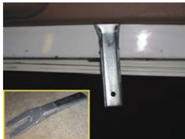
شکل ۲-۳۵- اهرم خاردرآر و نحوه‌ی استفاده از آن
