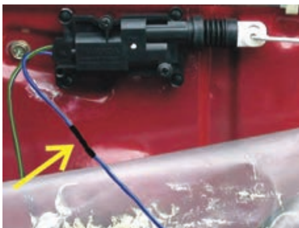
شکل ۴۹-۲- عایق کاری محل اتصال سیم‌ها به یکدیگر
