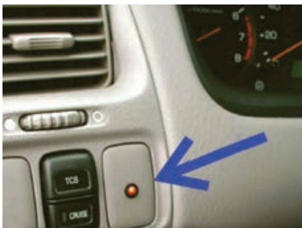
شکل ۲-۶۶ – محل نصب دیود نوری (LED) در یک نوع خودرو
