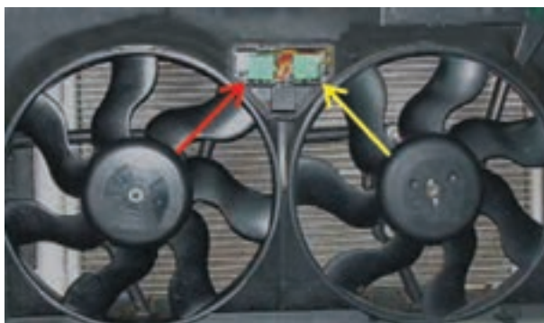
شکل ۱۱-۶- رله ی فن ها
