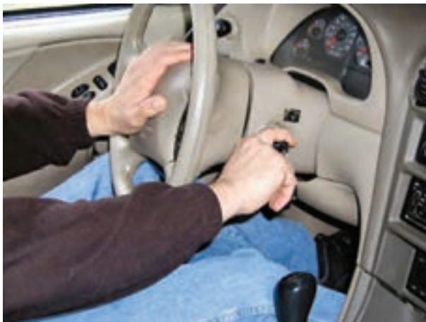
شکل ۴۵-۷- روشن کردن موتور
