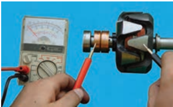
شکل ۷۴-۷- آزمایش اتصال بدنه نبودن سیم پیچ روتور
