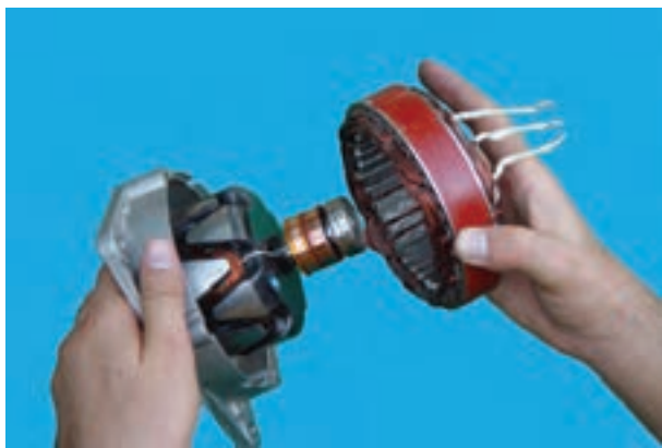
شکل ۶۲-۷ - جدا کردن استاتور
