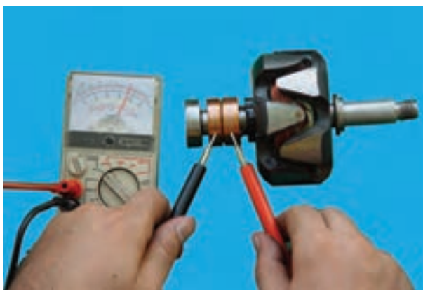
شکل ۷۵-۷- آزمایش سالم بودن سیم پیچ روتور
