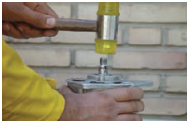
شکل ۶۳-۷ - بیرون آوردن روتور از درپوش
