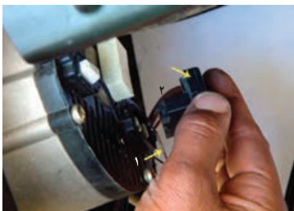
شکل ۷-۵۰ - جدا کردن خار و مغزی اتصال سیم از آلترناتور ۱- خار ۲- مغزی اتصال سیم
