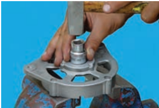
شکل ۶۹-۷ - بیرون آوردن بلبرینگ
