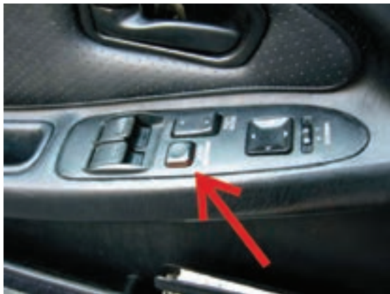
شکل ۱۳۷-۲- سوئیچ قفل کن سیستم شیشه بالابر
