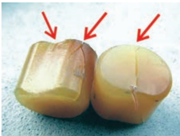
شکل ۱۲۶-۲- معیوب بودن بادامک‌ها
