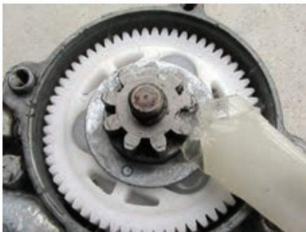
شکل ۱۳۰-۲- روغن کاری چرخ دنده ها
