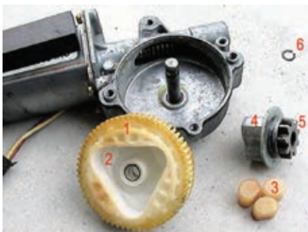
شکل ۱۲۵-۲- اجزای داخل پوسته‌ی گیربکس تعدیل دور
