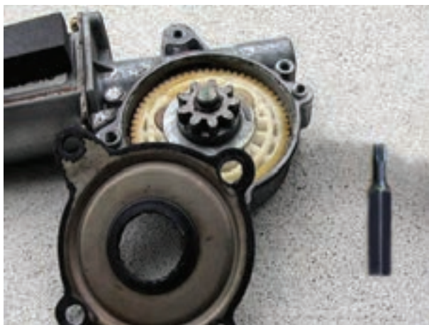
شکل ۱۲۴-۲- اجزای داخل جعبه دنده‌ی تعدیل دور
