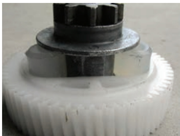
شکل ۱۲۸-۲ سوار کردن چرخ دنده‌ی فلزی
