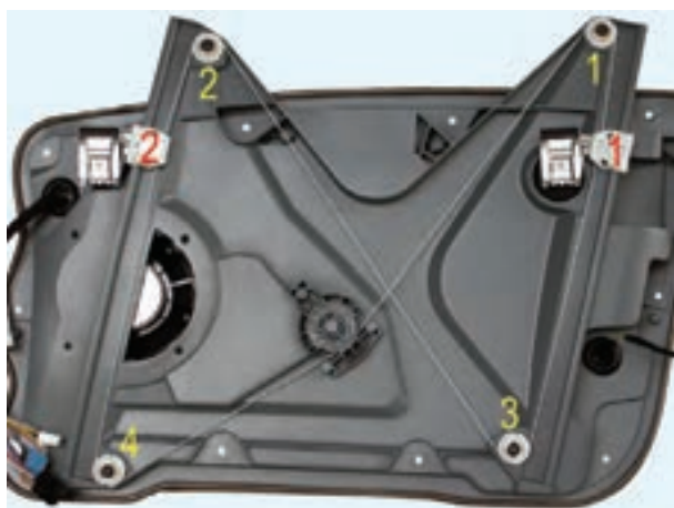
شکل ۱۰۶-۲- نحوه‌ی ارتباط رگلاتورهای مکانیزم شیشه بالابر
