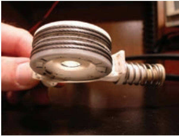
شکل ۲-۱۰۷- پولی اصلی مکانیزم شیشه بالابر یک نوع خودروی سواری
