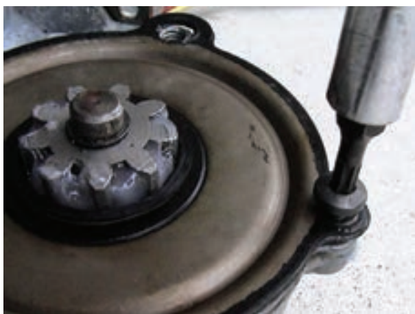
شکل ۱۳۱-۲- بستن پیچ های درپوش به بدنه
