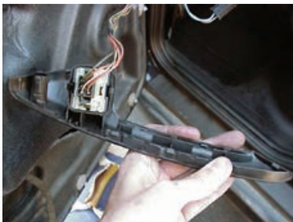
شکل ۱۱۸-۲- اتصال سوکت سوئیچ شیشه بالابر
