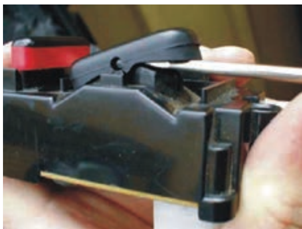
شکل ۲-۱۴۵- تعویض شستی معیوب
