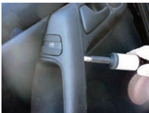
شکل ۲-۱۱۰- جدا کردن قاب سوئیچ شیشه بالابر
