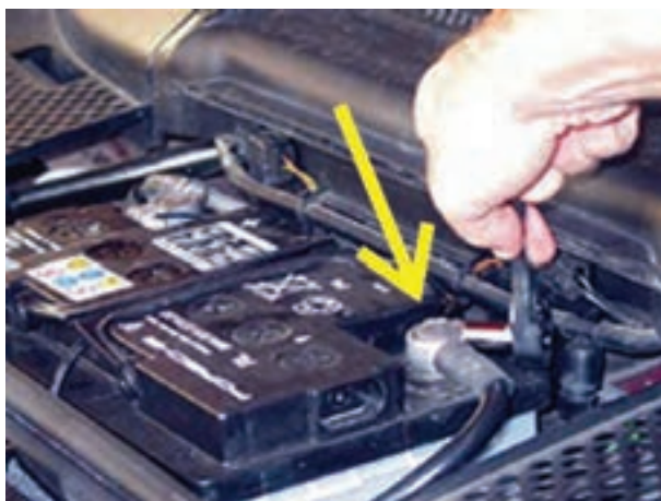
شکل ۱۴۱-۲- باز کردن کابل اتصال بدنه‌ی باتری
