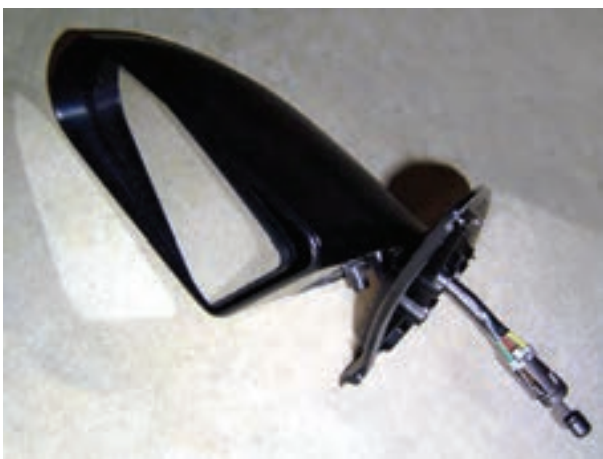
شکل ۱۵۶-۲- آینه‌ی جانبی و مکانیزم حرکت آن
