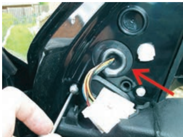
شکل ۱۷۸-۲ – باز کردن پیچ نگه‌دارنده‌ی پایه‌ی اصلی آئینه
