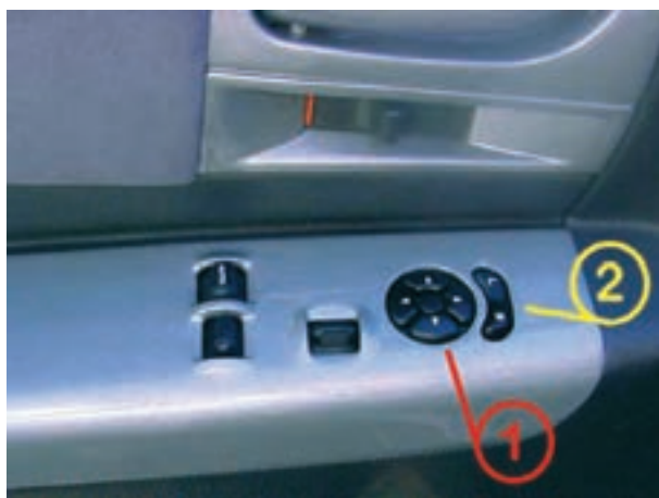
ب - مجموعه‌ی سوئیچ آینه‌های جانبی و شیشه بالابر شکل ۱۸۰-۲ - سوئیچ آینه‌های جانبی
