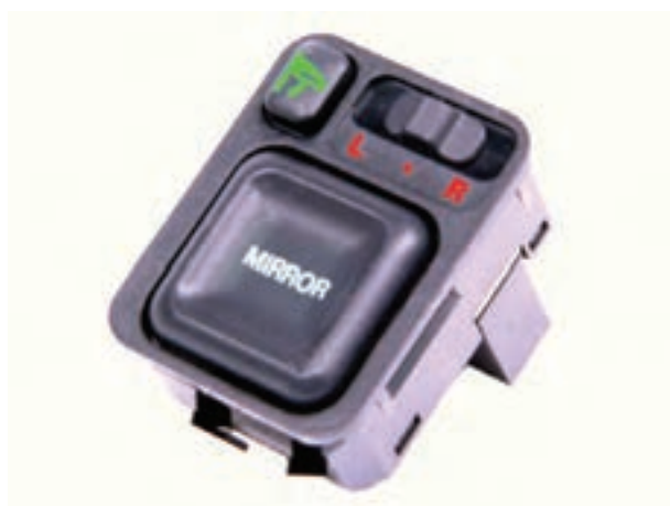
شکل ۱۹۱-۲- سوئیچ آینه های جانبی یک نوع خودرو
