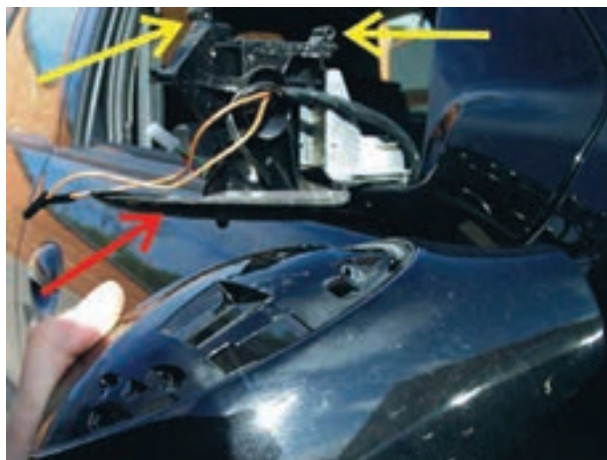
شکل ۱۷۷-۲- شاسی آینه ی جانبی و قاب بیرونی آینه پس از پیاده کردن آن
