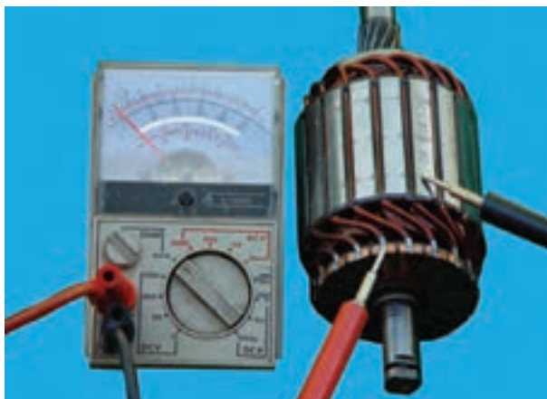
شکل ۸-۶۷- آزمایش اتصال کوتاه شدن آرمیچر
