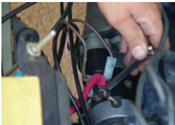
شکل ۸-۴۸- جدا کردن اتصالات الکتریکی استارت
