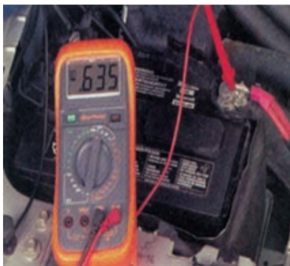
شکل ۸-۳۷ – اندازه‌گیری افت ولتاژ جریان ورودی کابل استارتر
