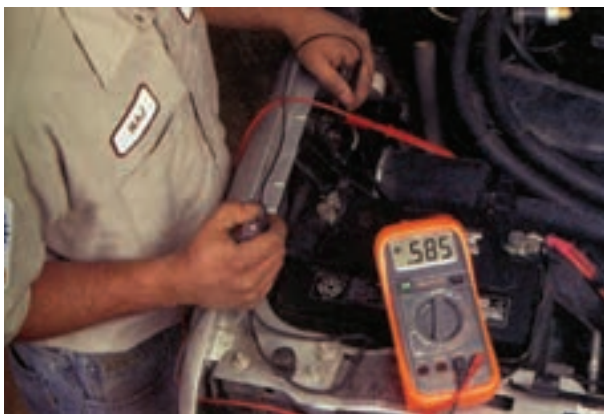
شکل ۸-۴۴- اندازه‌گیری افت ولتاژ پلاتین‌های سولونویید استارتر
