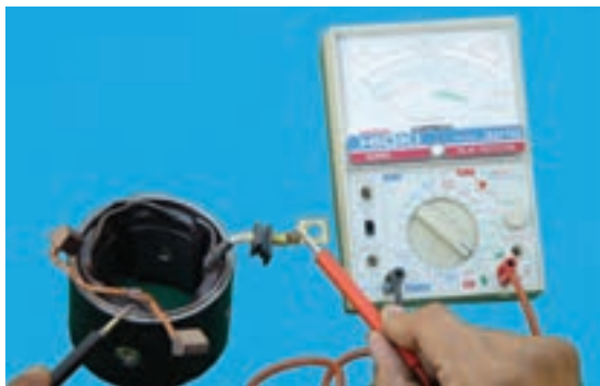
شکل ۸-۷۵- آزمایش اتصال بدنه‌ی بالشتک
