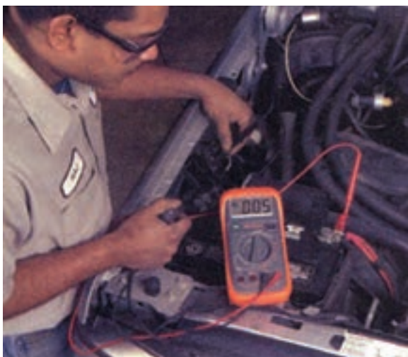
شکل ۸-۴۱- اندازه‌گیری افت ولتاژ کابل متصل به رله
