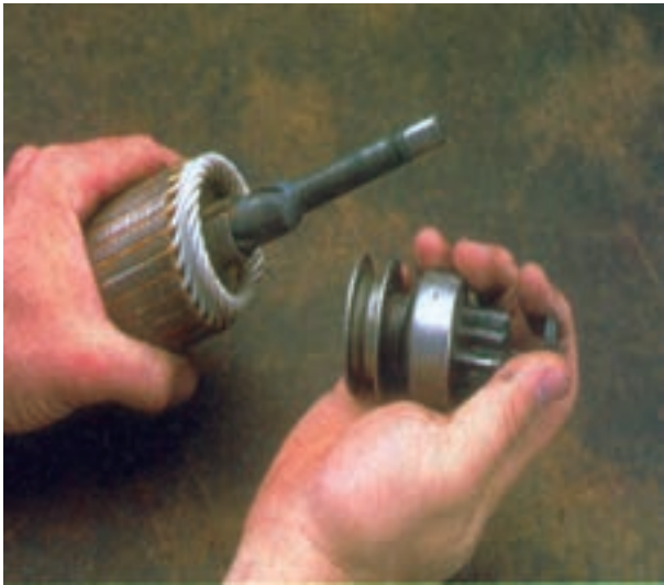
شکل ۸-۶۲ – خارج کردن مجموعه دنده‌ی استارتر از روی شافت
