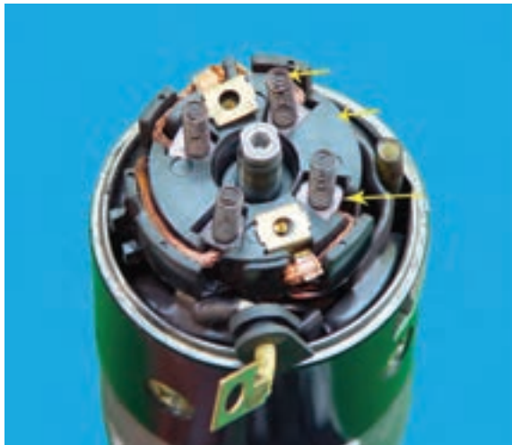
۱- فنر زغال ۲- پایه‌ی نگه‌دارنده‌ی زغال ۳- زغال شکل ۲۳-۸ - مجموعه‌ی زغال‌ها و نگه‌دارنده‌ی آنها
