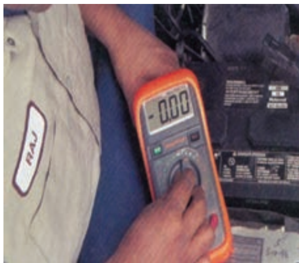
شکل ۸-۳۵- تنظیم مولتی متر روی شاخص ولتاژ
