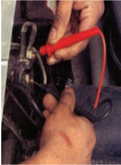
شکل ۸-۴۲- اتصال فیس‌های ولت‌متر به اتومات استارتر
