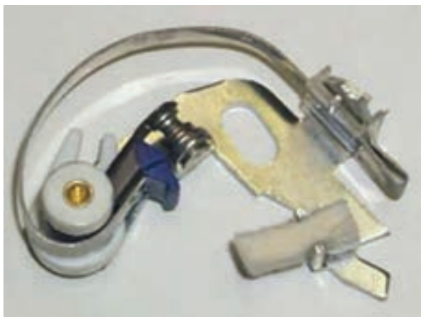
شکل ۲۲-۱۰- نمد روغن کاری بادامک
