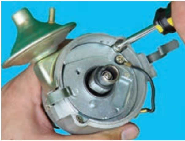
شکل ۱۹-۱۰- باز کردن پیچ‌های صفحه‌ی دلکو
