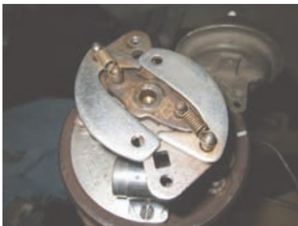
شکل ۲۴-۱۰- دستگاه آوانس وزنه‌ای دلکو
