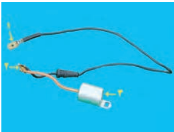
۱- سیم متصل به منفی کوئل ۲- محل اتصال به پلاتین ۳- خازن
