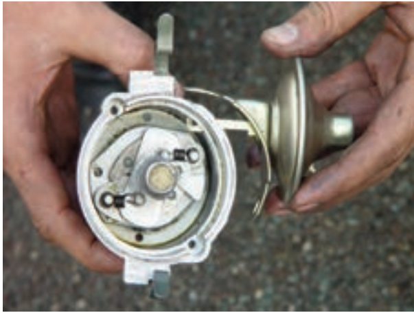
شکل ۳۱-۱۰ جدا کردن مجموعه‌ی آوانس خلئی
