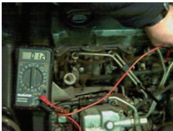
شکل ۱۳-۲۳- اندازه‌گیری مقاومت شمع گرم‌کن سیلندر چهارم
