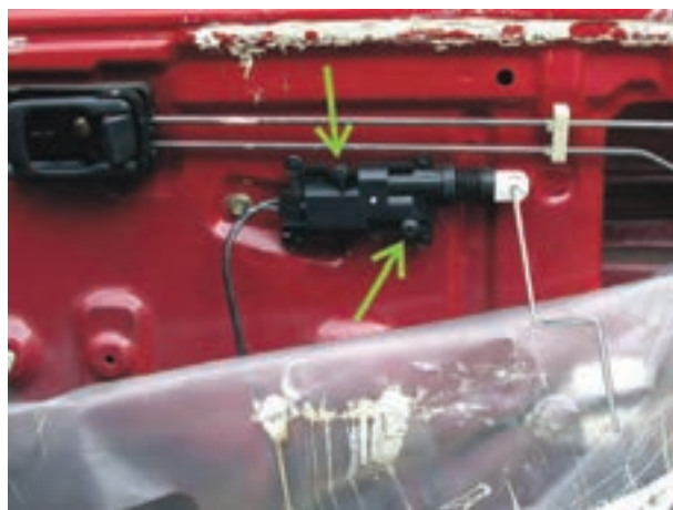
شکل ۲-۲۹ اتصال عملگر الکتریکی در روی در خودرو
