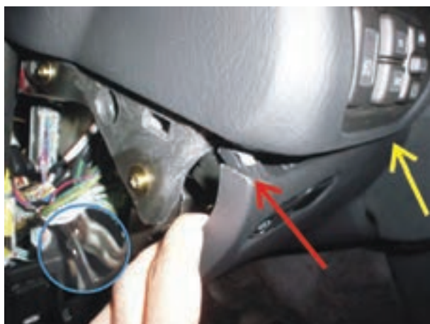
شکل ۸۵-۱- خارج کردن قاب از روی بدنه‌ی پانل
