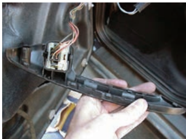
شکل ۱۱۸-۲ اتصال سوکت سوئیچ شیشه بالابر
