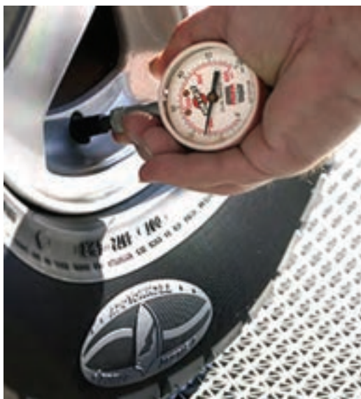
شکل ۱۵۸-۱- کنترل فشار باد تایر
