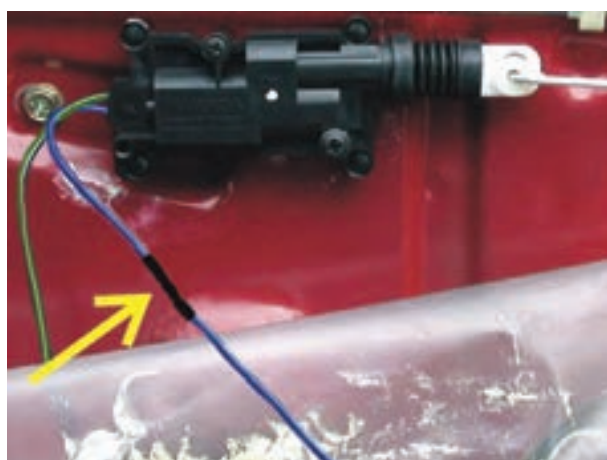
شکل ۴۹-۲ عایق کاری محل اتصال سیم‌ها به یکدیگر
