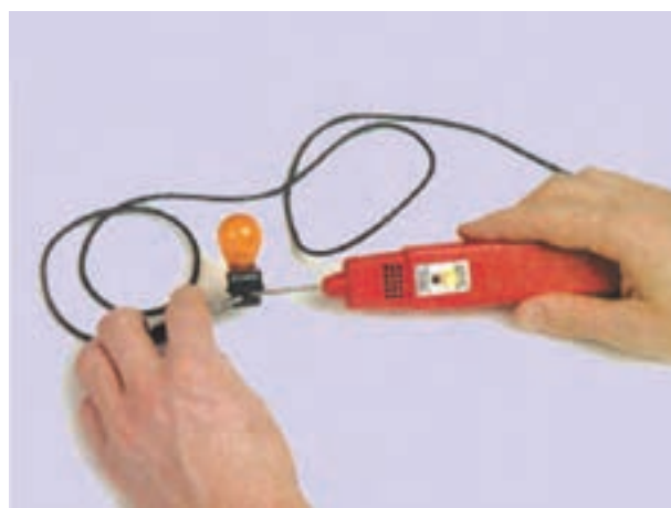
شکل ۱۸۲-۱- آزمایش لامپ چراغ راهنما
