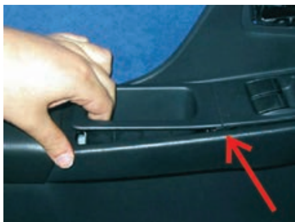
شکل ۱۸۳-۲ خارج نمودن قاب سوئیچ‌ها
