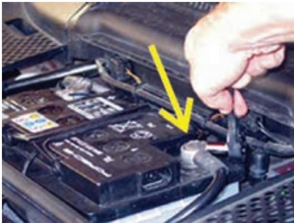
شکل ۱۴۱-۲ باز کردن کابل اتصال بدنه‌ی باتری
