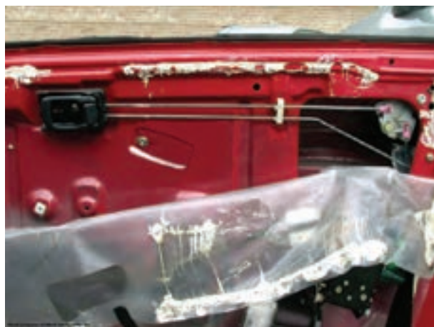
شکل ۲-۲۶- جدا کردن پلاستیک محافظ روی در
