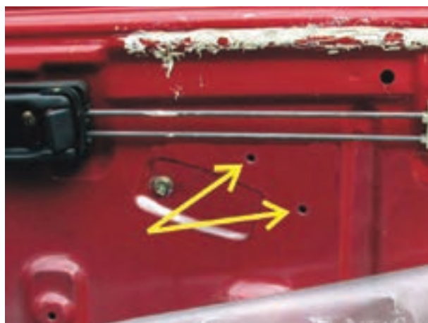
شکل ۲-۲۷ سوراخ کاری بدنه‌ی داخلی در خودرو
