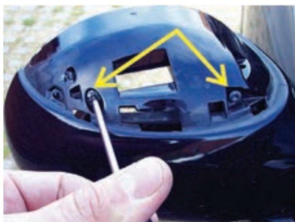
شکل ۱۷۴-۲ باز کردن پیچ‌های قاب بیرونی آینه
