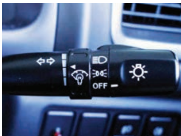
شکل ۱-۷۲- سوئیچ چراغ‌های روشنایی (طرح دسته‌ی راهنما)
