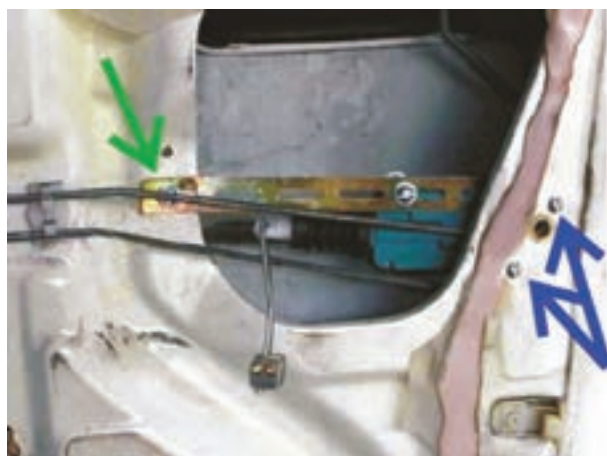
شکل ۳۹-۲ باز کردن پیچ‌های اتصال عملگر الکتریکی
