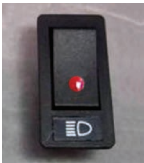
شکل ۸۱-۱- سوئیچ چراغ‌های جانبی (پارک)
