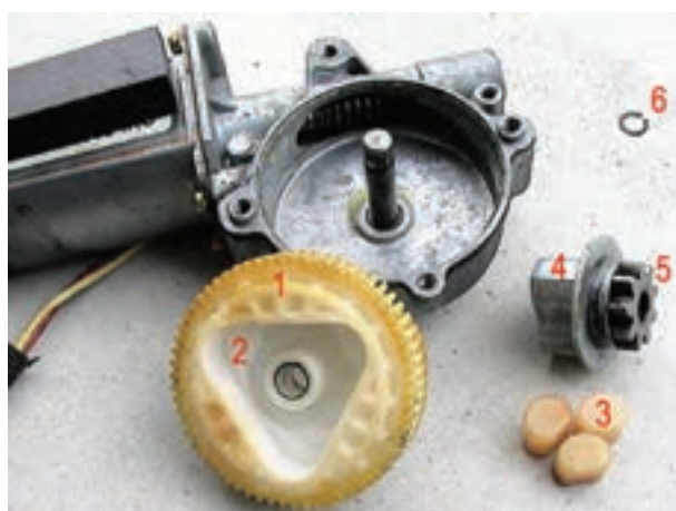
شکل ۱۲۵-۲- اجزای داخل پوسته‌ی گیربکس تعدیل دور
