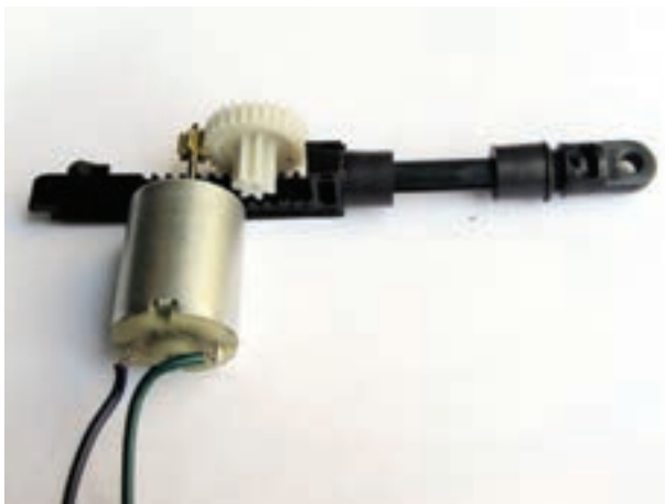
شکل ۲-۲۰- نحوه‌ی ارتباط چرخ‌دنده‌ها هنگام تبدیل دور
