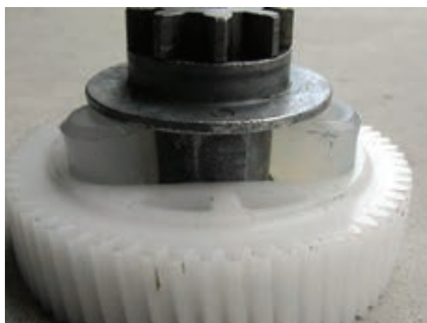
شکل ۱۲۸-۲ سوار کردن چرخ دنده‌ی فلزی
