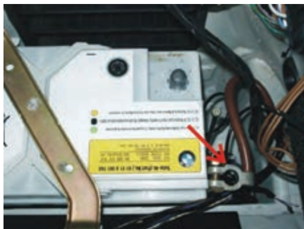
شکل ۳۵-۱ جدا کردن بست اتصال کابل بدنه‌ی باتری
