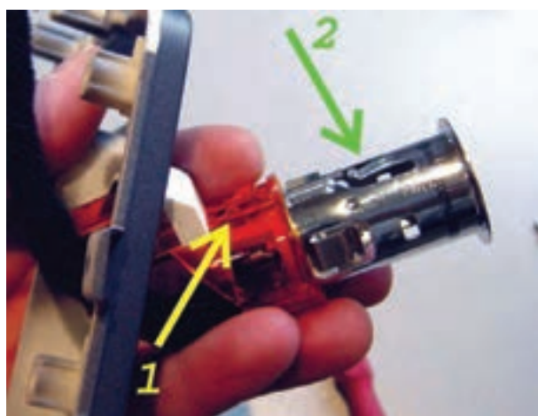
شکل ۱-۲۲۶- خارهای اتصال فندک
