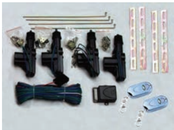
شکل ۲-۴- قطعات مدار الکتریکی قفل مرکزی
