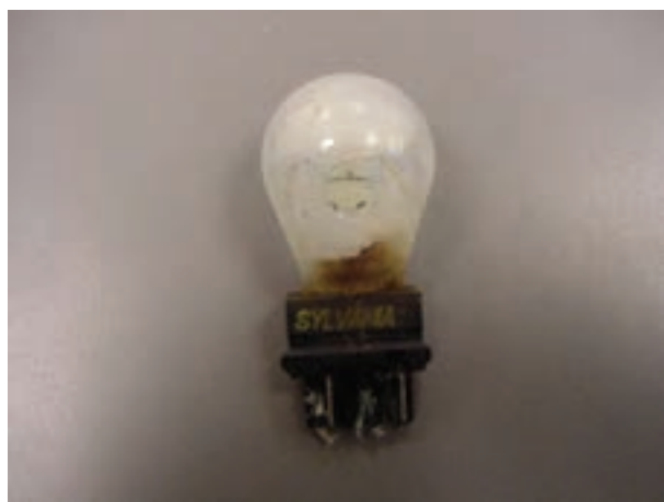
شکل ۱۴۱- اثر عوامل فیزیکی در معیوب شدن لامپ
