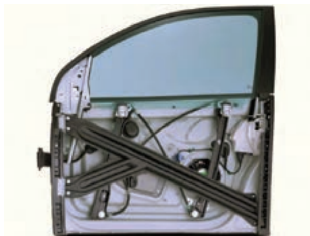
شکل ۹۶-۲- شیشه بالابر الکتریکی
