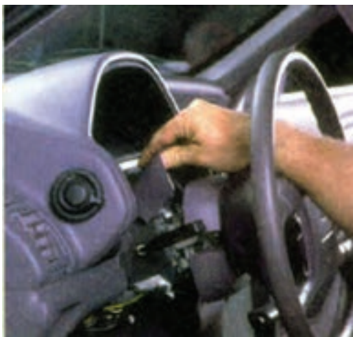
شکل ۹۱-۱- بیرون آوردن قاب سوئیچ روشنایی
