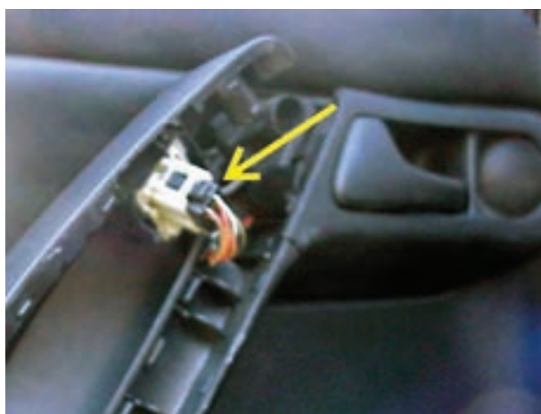
شکل ۲-۱۱۱- سوکت سوئیچ شیشه بالابر
