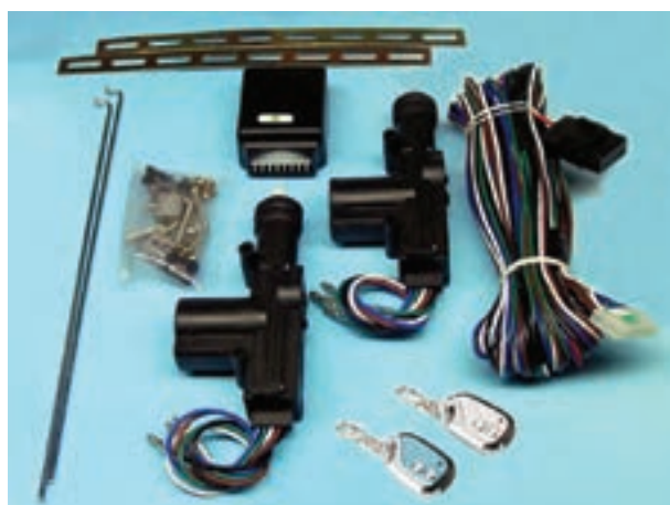
شکل ۲-۱- اجزای مدار قفل مرکزی
