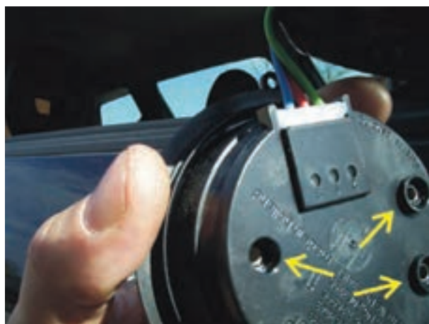
شکل ۱۷۲-۲ جدا کردن محفظه‌ی موتورهای الکتریکی
