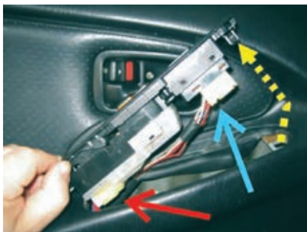
شکل ۲-۱۸۶- اتصال سیم‌کشی مدار الکتریکی به سوئیچ‌های روی پانل در سمت راننده در یک نوع خودرو
