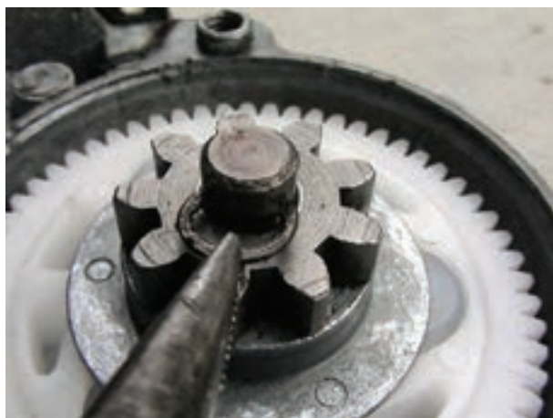
شکل ۱۲۹-۲ جانداختن خار فنری
