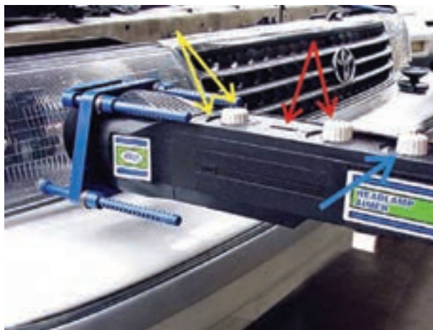
شکل ۱۶۱-۱- پیچ‌های تنظیم دستگاه تنظیم نور چراغ‌ها
