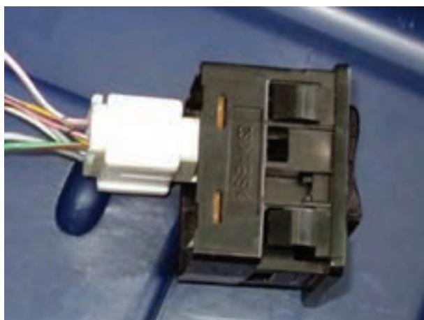
شکل ۱-۷۰- سوئیچ چراغ بزرگ جلو روی پانل
