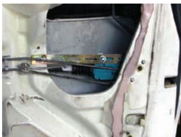
شکل ۳۷-۲ نحوه‌ی اتصال عملگر الکتریکی
