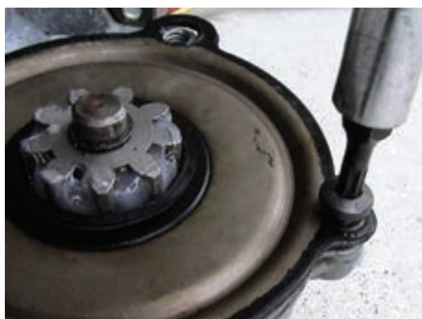
شکل ۱۳۱-۲- بستن پیچ های درپوش به بدنه
