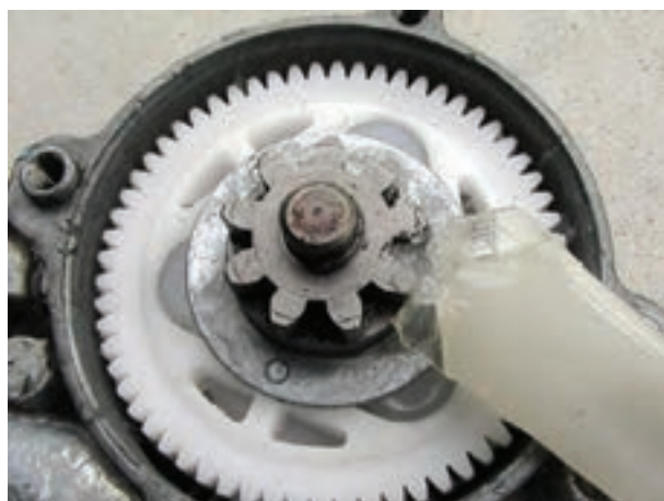
شکل ۱۳۰-۲- روغن کاری چرخ دنده ها
