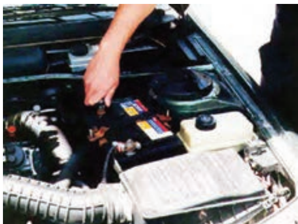
شکل ۱۶۴-۲ بازکردن کابل اتصال بدنه‌ی باتری
