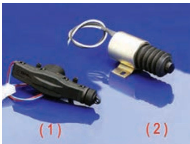
۱- موتوردار ۲- سولفونیدی شکل ۹-۲ دو نوع عملگر سیستم قفل مرکزی
