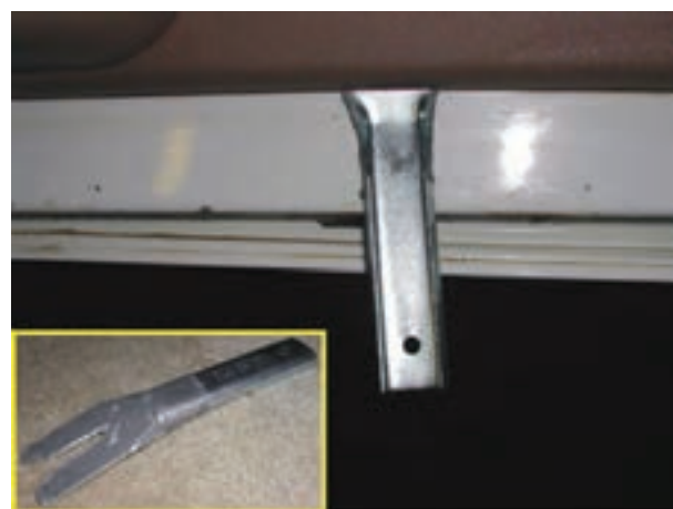
شکل ۲-۳۵- اهرم خاردرآر و نحوه‌ی استفاده از آن
