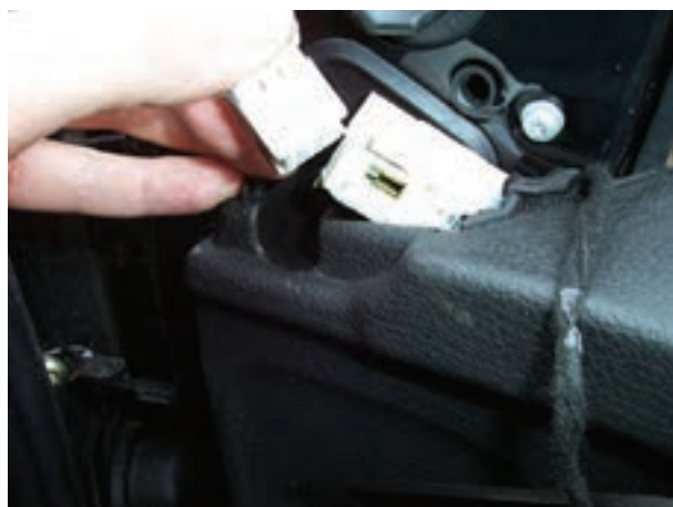
شکل ۱۶۶-۲- جدا کردن سوکت سیم کشی آینه
