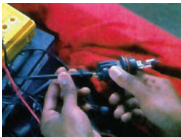
شکل ۱۴۲- آزمایش لامپ چراغ‌های بزرگ جلو
