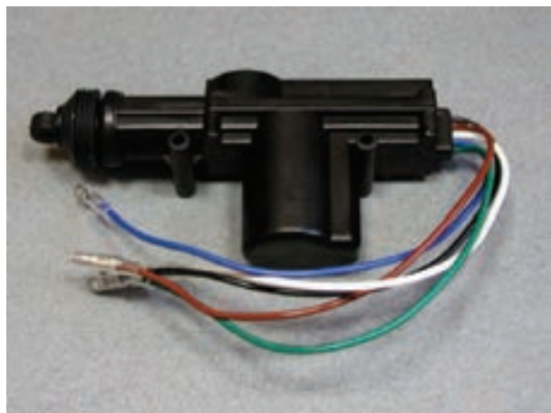
شکل ۲-۲۴- عملگر الکتریکی پنج سیمی
