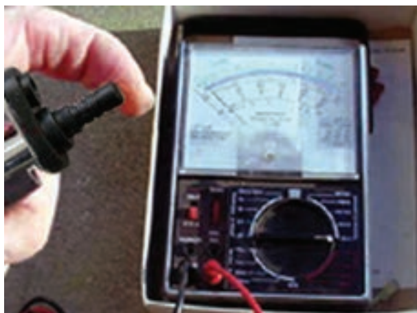
شکل ۱۹۶-۱- آزمایش سوئیچ لای در
