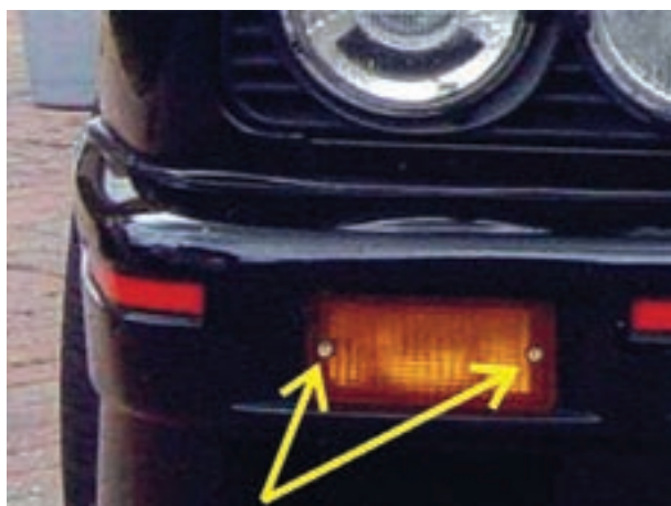
شکل ۱-۵۰ پیچ‌های اتصال تلق چراغ راهنما
