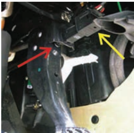
شکل ۱-۷۷- محل نصب سوئیچ مکانیکی ترمز
