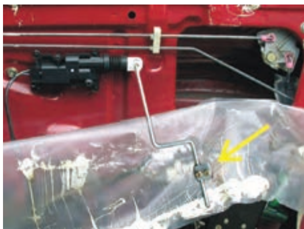
شکل ۲-۳۰- سوار کردن بست فلزی رابط در روی میله‌ی متصل به عملگر الکتریکی
