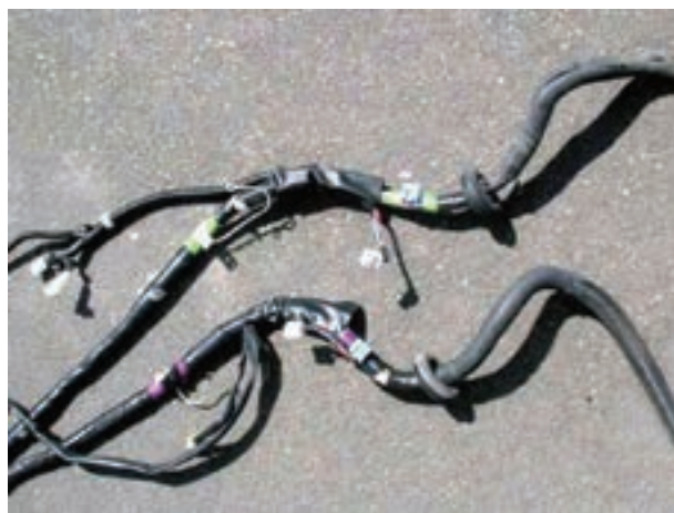
شکل ۱۳۷-۱- کلاف سیم کشی یک نوع خودرو
