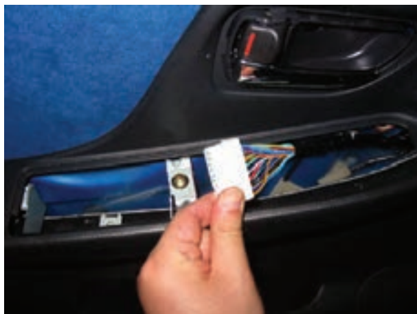
شکل ۲-۱۸۵- سوکت اتصال دسته سیم به سوئیچ‌ها
