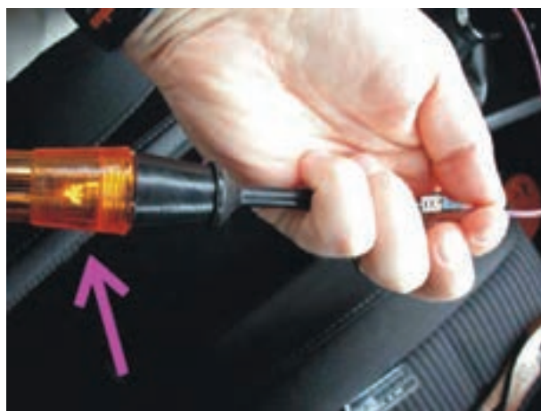
شکل ۱۵۲-۲- استفاده از چراغ آزمایش برای تشخیص سیم حامل جریان الکتریکی
