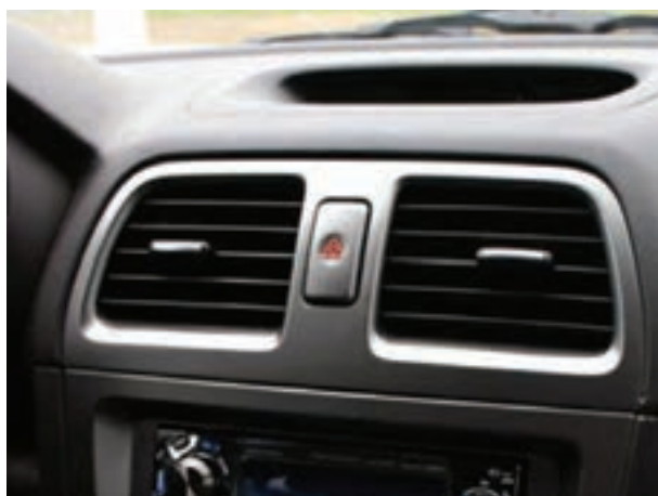
شکل ۱۷۳-۱ سوئیچ فلاشر یک نوع خودرو
