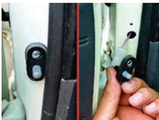
شکل ۱۹۲-۱- باز کردن سوئیچ لای در
