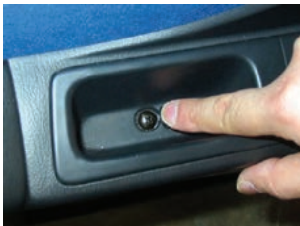
شکل ۱۸۲-۲ پیچ اتصال قاب سوئیچ به بدنه
