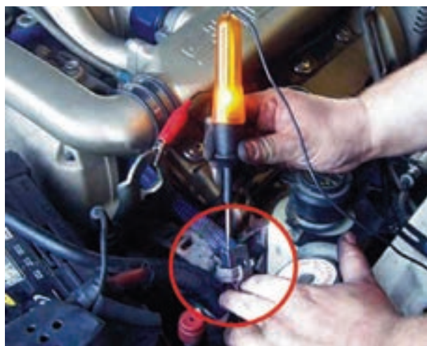
شکل ۱۴۵-۱- آزمایش برقراری جریان مدار چراغ‌های روشنایی
