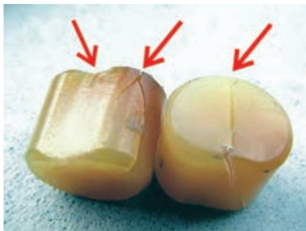
شکل ۱۲۶-۲- معیوب بودن بادامک‌ها
