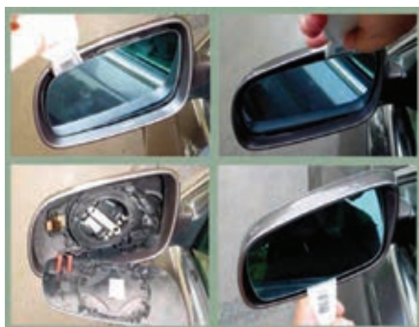
شکل ۱۶۷-۲- بیرون آوردن آینه از داخل قاب آن
