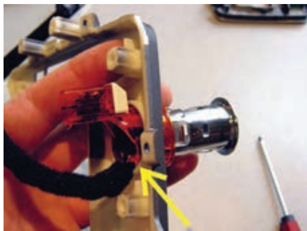
شکل ۱-۲۳۲ خارج کردن فندک
