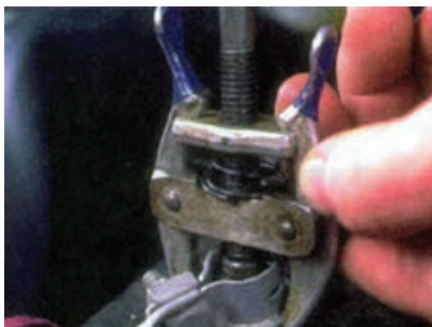
شکل ۱-۸۹- باز کردن بست اتصال بدنه‌ی باتری
