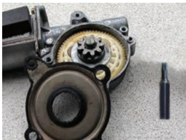
شکل ۱۲۴-۲- اجزای داخل جعبه دنده‌ی تعدیل دور
