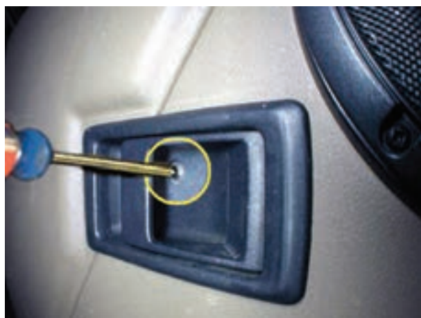
شکل ۳۶-۲ باز کردن قاب دستگیره‌ی قفل در
