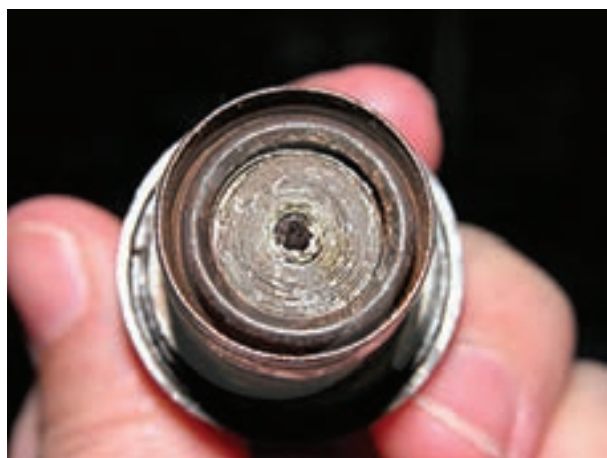
شکل ۱-۲۲۵- المنت حرارتی داخل سوئیچ فشاری
