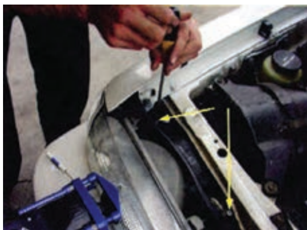
شکل ۱۶۷-۱- پیچ‌های تنظیم چراغ بزرگ جلو
