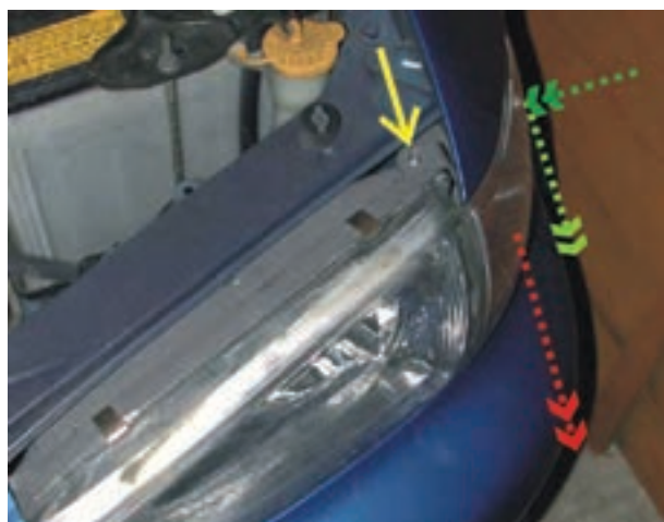
شکل ۱-۳۸- نحوه‌ی جدا کردن چراغ جانبی روشنایی
