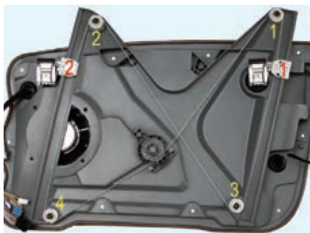
شکل ۱۰۶-۲- نحوه‌ی ارتباط رگلاتورهای مکانیزم شیشه بالابر
