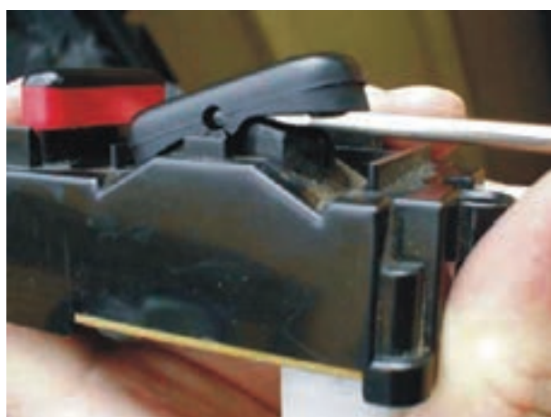
شکل ۲-۱۴۵ - تعویض شستی معیوب
