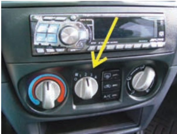
شکل ۴-۵۲- سوئیچ فن چهار وضعیتی
