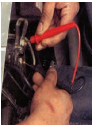
شکل ۸-۴۲ اتصال فیض‌های ولت‌متر به اتومات استارتر
