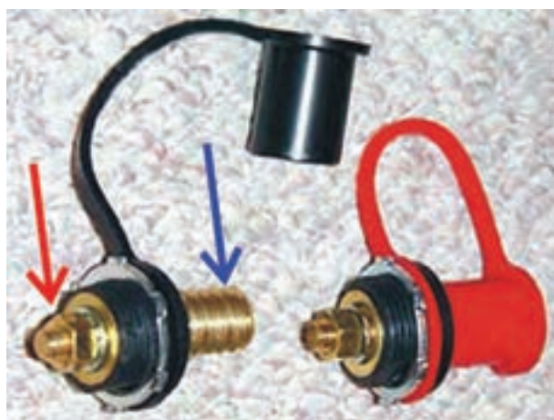
شکل ۱۴-۲- واسطه‌ی اتصال ترمینال باتری
