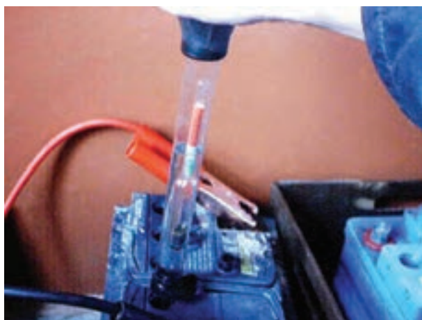
شکل ۱-۵۳- کنترل غلظت الکترولیت
