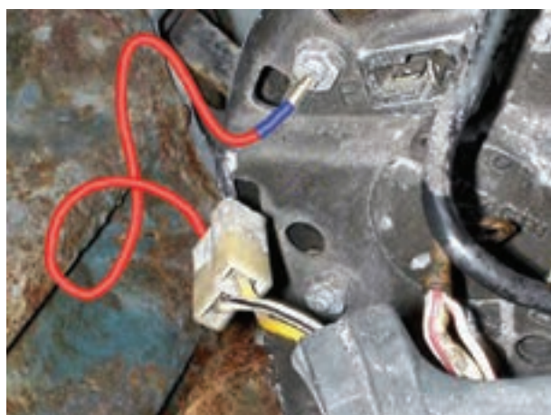
شکل ۳-۳۶ - آزمایش مدار لامپ شارژ
