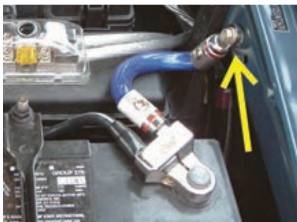
شکل ۲-۲۴ اتصال کابل منفی باتری به بدنه
