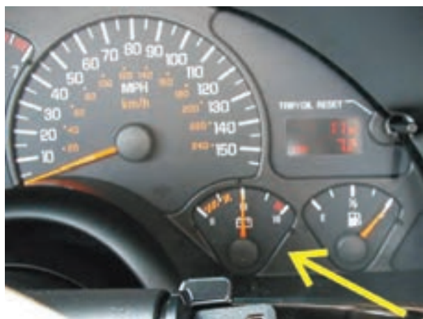
شکل ۱-۷۸ – نشان دهنده‌ی وضعیت شارژ باتری
