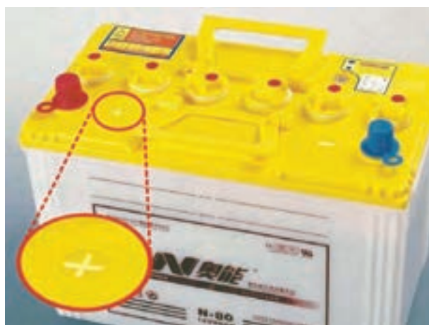
شکل ۲-۹- کاربرد علائم برای تشخیص قطب‌های باتری
