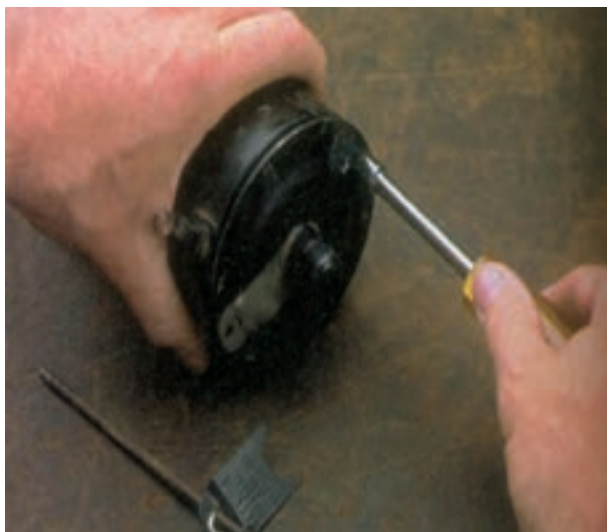
شکل ۸-۵۵ – باز کردن پیچ‌های اتصال درپوش به بدنه
