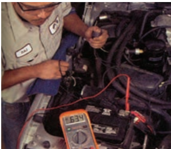
شکل ۸-۳۹- آزمایش افت ولتاژ باتری به خروجی رله
