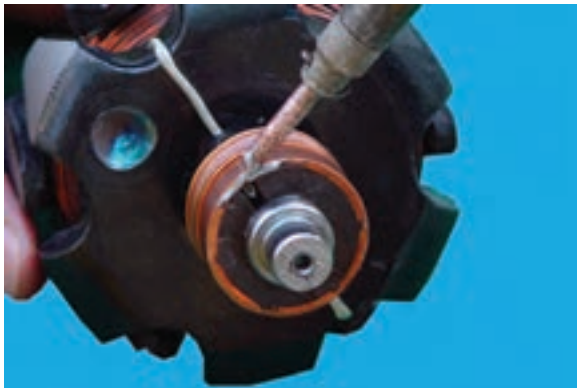
شکل ۶۶-۷ – جدا کردن سیم های روتور از کلکتور
