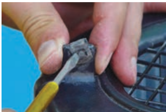
شکل ۴-۳۸ – باز کردن ضامن خار
