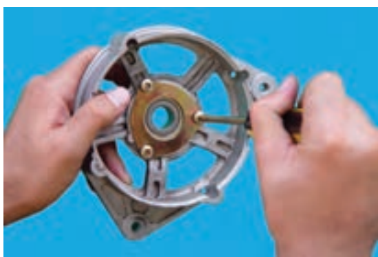
شکل ۶۷-۷ - باز کردن پیچ‌های نگه‌دارنده‌ی بلبرینگ
