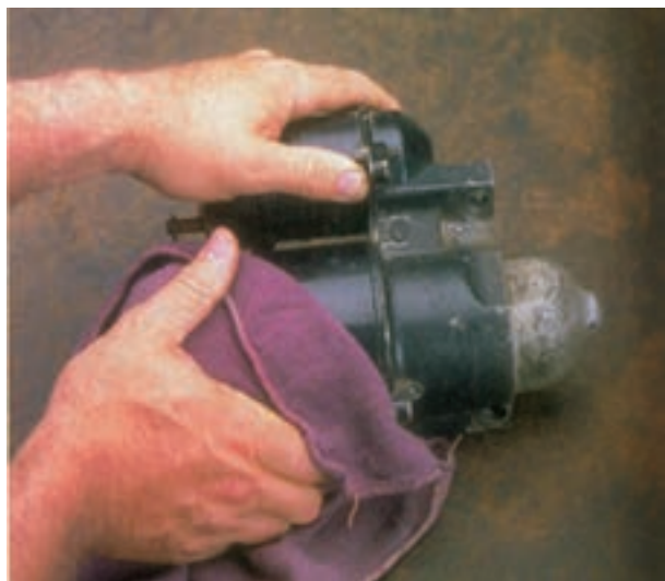
شکل ۸-۵۰ - تمیز کردن استارتر
