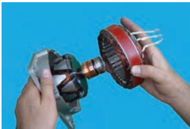
شکل ۶۲-۷ — جدا کردن استاتور
