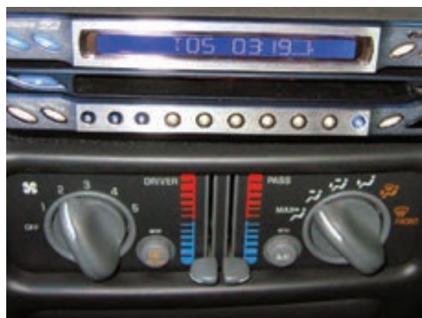
شکل ۵-۲۳ سوئیچ راه‌انداز فن کولر
