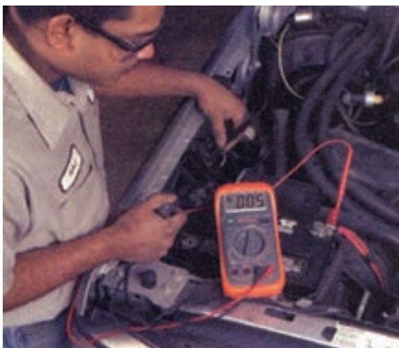
شکل ۸-۴۱- اندازه‌گیری افت ولتاژ کابل متصل به رله
