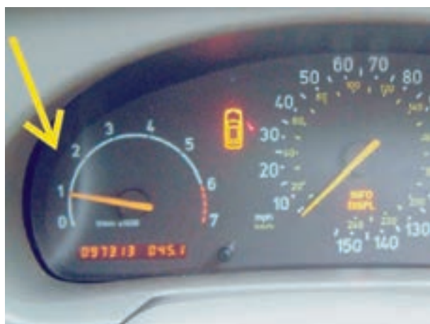
شکل ۷-۱۰- حالت دور آرام موتور
