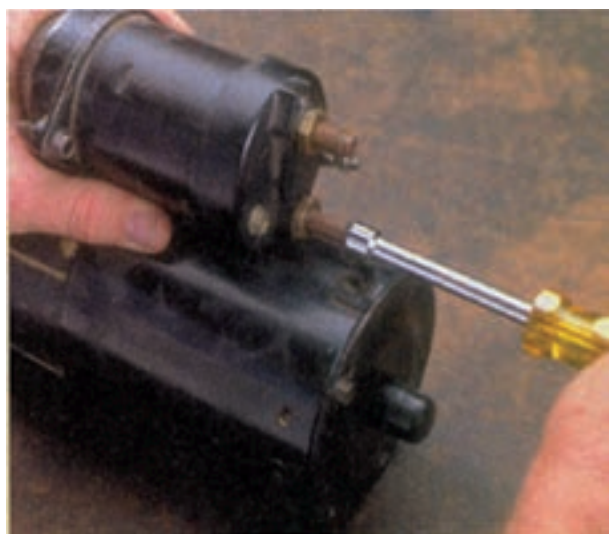
شکل ۸-۵۲ - باز کردن پیچ‌های اتصال اتومات به استارتر
