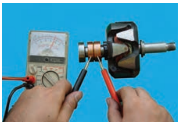
شکل ۷-۷۵ - آزمایش سالم بودن سیم پیچ روتور
