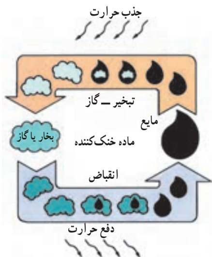
شکل ۵-۳- مراحل تغییر ماده خنک کننده
