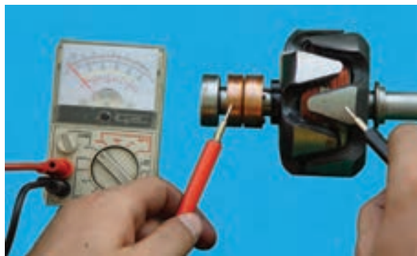
شکل ۷-۷۴ - آزمایش اتصال بدنه نبودن سیم پیچ روتور
