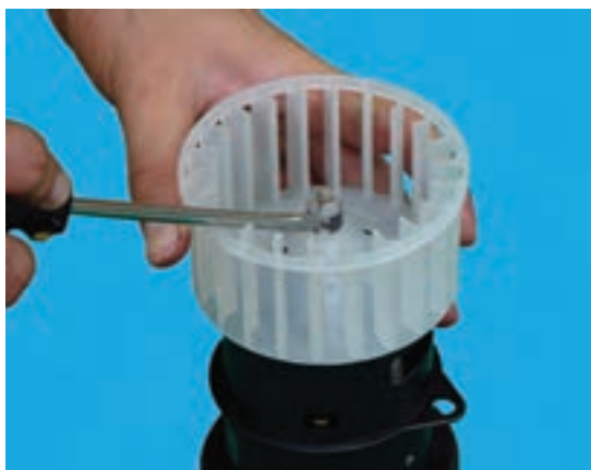
شکل ۴-۴۲ درآوردن خار نگهدارنده‌ی فن
