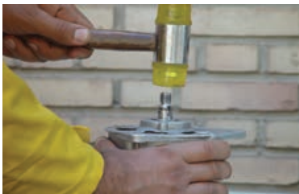
شکل ۶۳-۷ — بیرون آوردن روتور از درپوش
