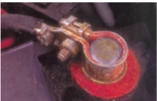
شکل ۱-۹۷- گریس زدن بست قطب‌ها
