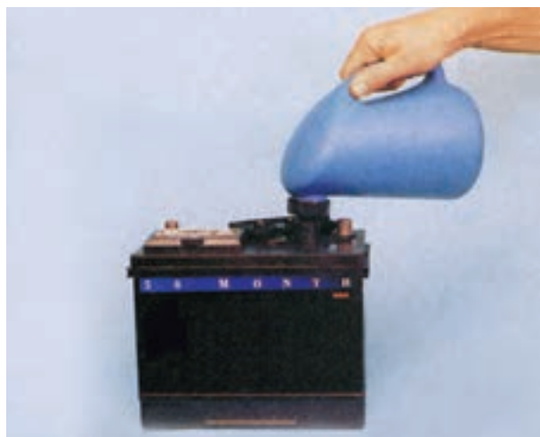
شکل ۲۷-۱- پر کردن خانه‌های باتری نو با الکترولیت
