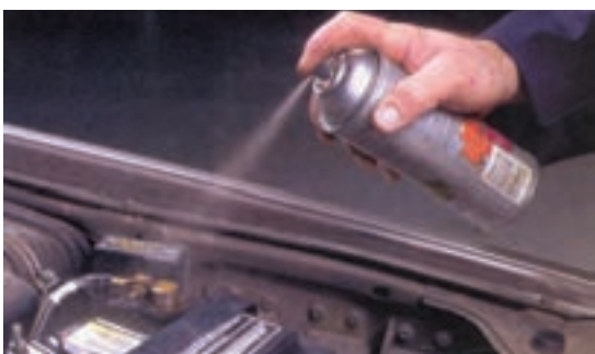
شکل ۱-۹۶- پاشیدن محلول ضد خوردگی روی بست
