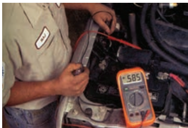
شکل ۸-۴۴ اندازه‌گیری افت ولتاژ پلاتین‌های سولونوید استارتر
