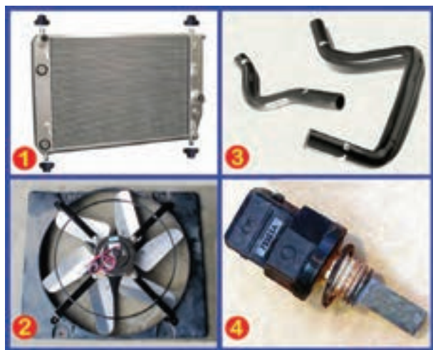
شکل ۲-۶- اجزای مدار خنک کاری
