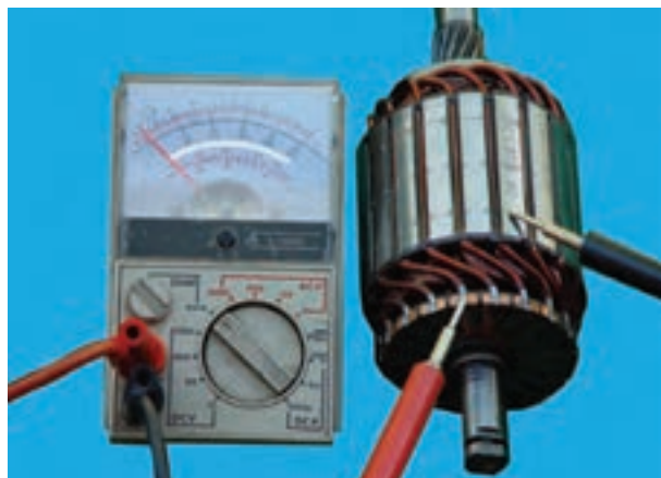
شکل ۸-۶۷ — آزمایش اتصال کوتاه شدن آرمیچر
