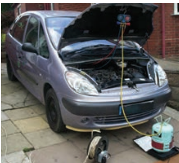
شکل ۳۵-۵ شارژ گاز کولر
