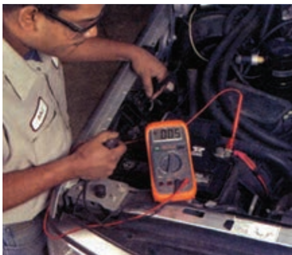
شکل ۸-۴۰- اتصال سیم منفی ولت‌متر به ورودی رله
