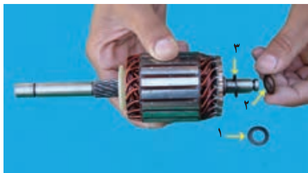
۱- واشر فلزی ۲- واشر فیبری ۳- واشر فلزی
