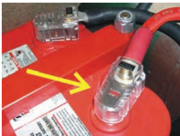
شکل ۲-۱۹- مورد استفاده تلق محافظ قطب‌های باتری
