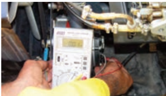
شکل ۷۲-۷۱ - اتصال ولت‌متر بین ترمینال B و بدنه
