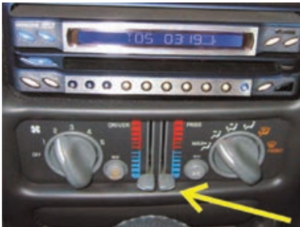
شکل ۴-۵۴- اهرم‌های تنظیم هوای ورودی
