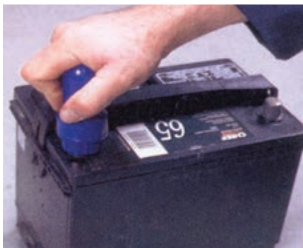
شکل ۸۹-۱ - نحوه‌ی استفاده از ابزار مخصوص باتری
