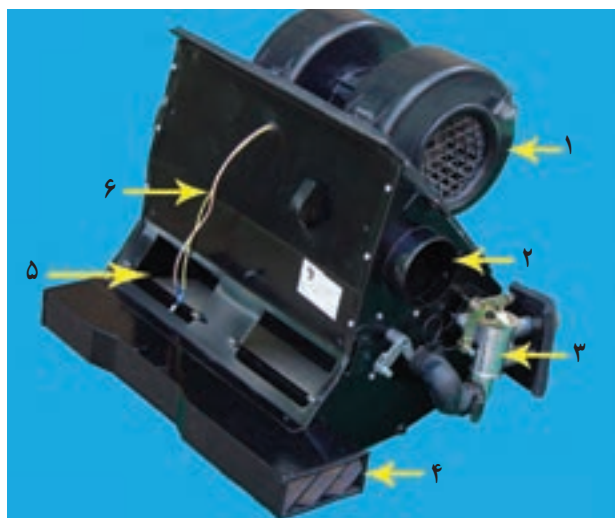
شکل ۴-۴ مجموعه‌ی کامل بخاری: ۱- موتور و فن ۲- محل اتصال خرطومی بغل ۳- شیر آب بخاری ۴- خروجی زیر پا ۵- خروجی کانال‌های زیر شیشه ۶- سیم‌های الکتریکی موتور
