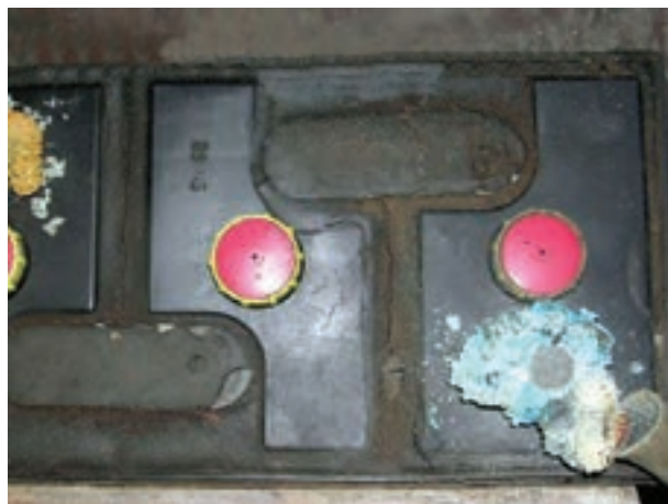
شکل ۱-۷۹ – سولفاته شدن قطب باتری
