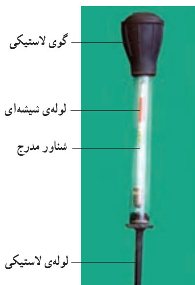
شکل ۱-۱۴- دو نوع هیدرومتر یا چگالی سنج
