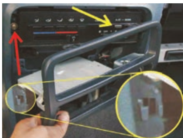
شکل ۳۸-۵ باز کردن قاب سوئیچ‌ها
