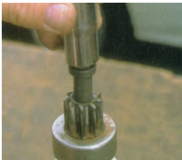
شکل ۸-۶۰ – خارج کردن حلقه رینگ‌ی از شیار شافت
