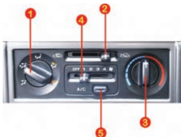
شکل ۵-۲۴ اهرم‌های تنظیم روی پانل راننده
