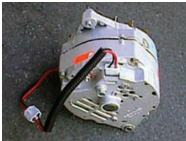
شکل ۳-۱۶- آلترناتور مجهز به آفتامات الکترونیکی
