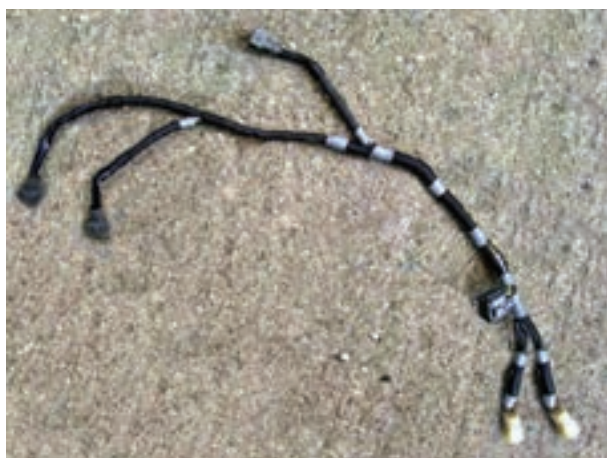
شکل ۱۲-۳- دسته سیم مدار شارژ
