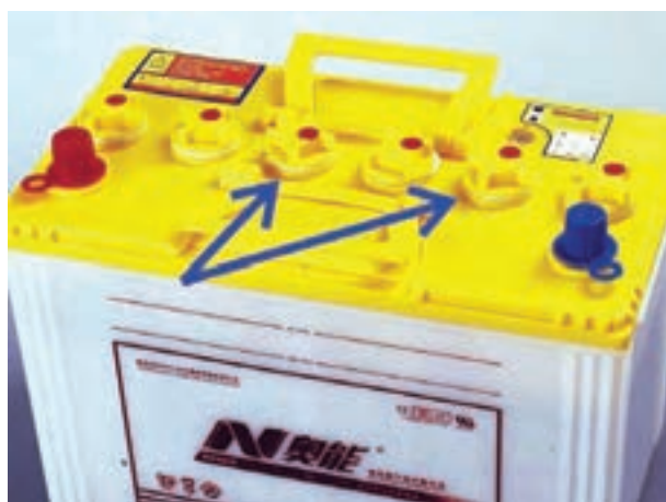
شکل ۱-۴- درپوش خانه‌های باتری
