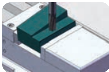
فرزکاری سطح تا خط کشیده شده بر روی قطعه
