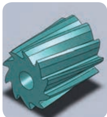
تیغه فرز دارای لبه‌های برنده مارپیچ
