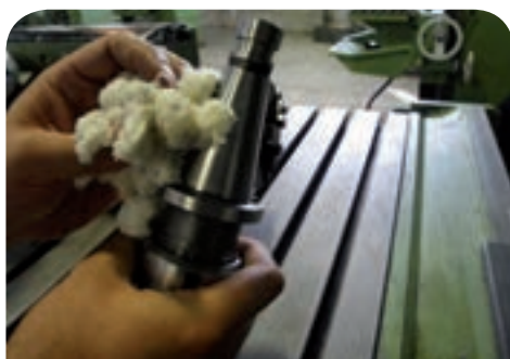
تمیز کردن دنباله میله فرزگیر
