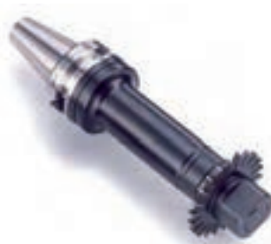
بستن تیغه فرز پولکی در میله فرز‌گیر یکطرفه
