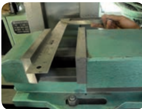
تنظیم فک‌های گیره با استفاده از گونیا
