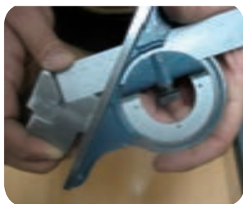
کنترل شیب قطعه با زاویه سنج انیورسال
