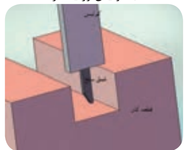
اندازه گیری عمق شیار
