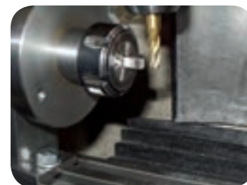
چهارگوش کردن قطعه به کمک دستگاه تقسیم
