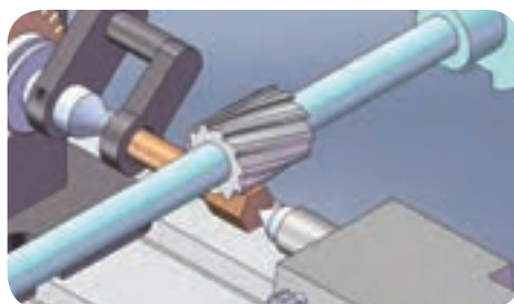
دید کلی از نحوه چند ضلعی کردن قطعه وی ماشین فرز افقی
