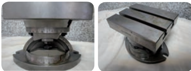
میز زاویه دار قابل تنظیم
