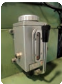
دو نمونه نمایش گر سطح روغن دستگاه
