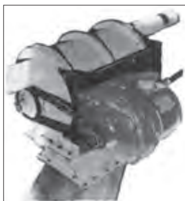
شکل ۱۱۰ - انتقال قدرت با چرخ و زنجیر
