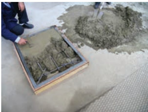
شکل ۶-۱- پر کردن قالب با ملات مناسب
