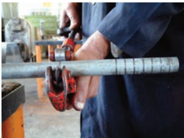
شکل ۱-۶۵- انتقال خطوط خط کشی شده به دور لوله
