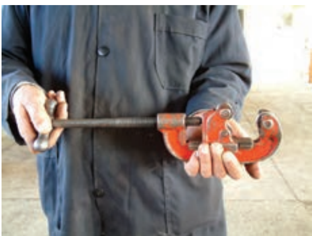
شکل ۱-۵۴ - باز کردن دهانه‌ی لوله‌بر
