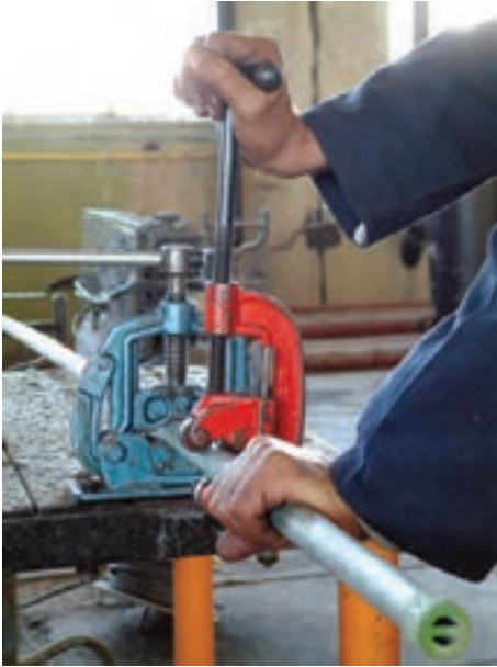
شکل ۱-۵۸- ادامه‌ی عمل بُرش‌کاری
