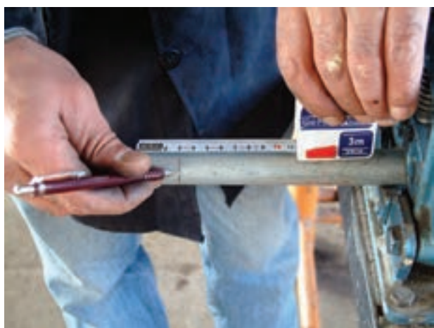
شکل ۱-۷- علامت‌گذاری کردن لوله با متر و مداد
