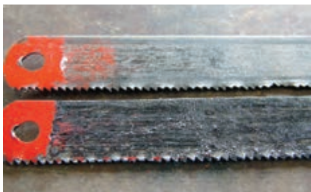
شکل ۱-۴۷- تیغه اره‌های دندان‌های شکسته شده
