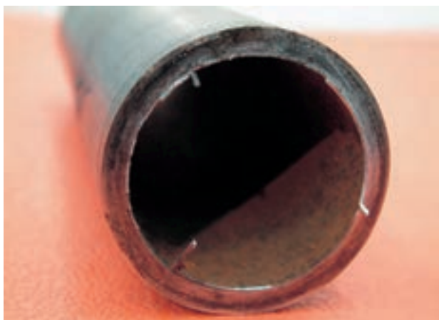
الف - لوله‌ی بریده شده به وسیله‌ی لوله‌بر
