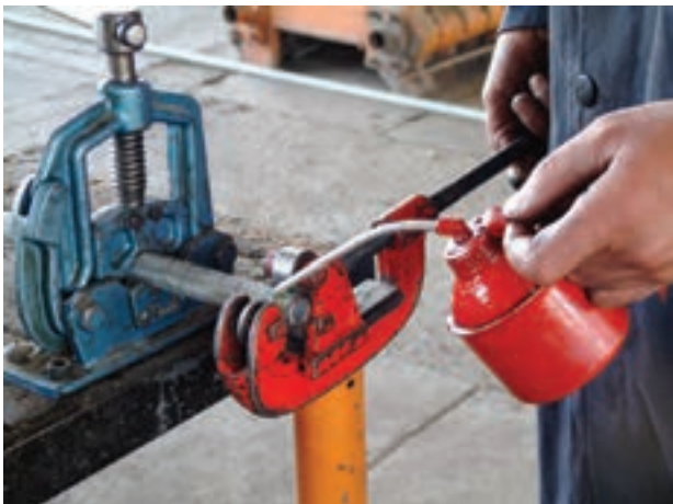
شکل ۱-۵۷- ریختن روغن در محل تماس
