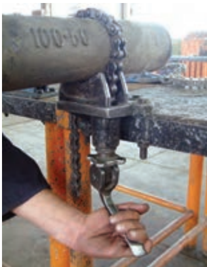
شکل ۱-۳۳- کشیدن اهرم قفل‌کننده
