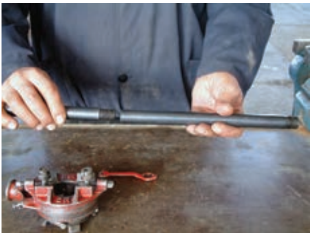
شکل ۴-۲۴- اتصال دسته‌ی دو تکه به یکدیگر
