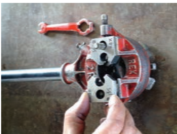
شکل ۴-۲۶- قرار دادن پارچه‌ها در محل خود
