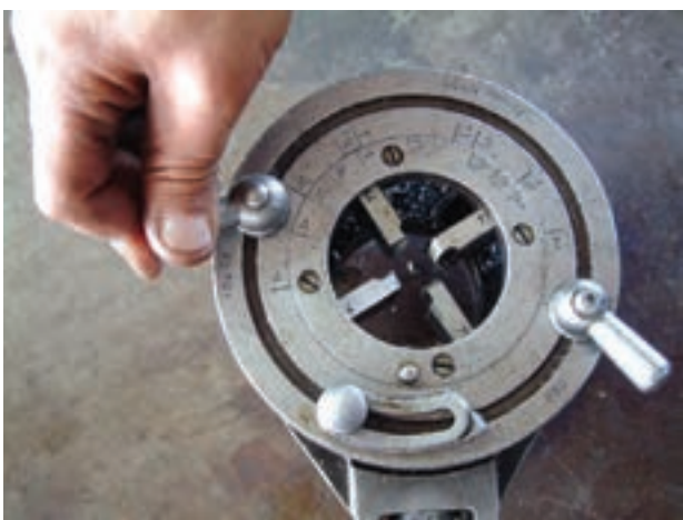
شکل ۴-۶۲- سفت کردن مهره‌های ثابت‌کننده‌ی رینگ متحرک
