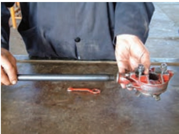
شکل ۴-۲۵- اتصال دسته‌ی حدیده به بدنه‌ی حدیده
