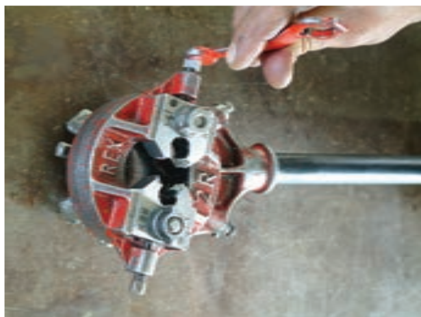
شکل ۲۰-۴- اجزای حدیده‌ی دستی دو پارچه
