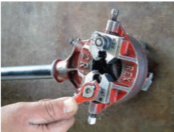
شکل ۴-۲۸ - سفت کردن مهره به وسیله‌ی آچار حدیده
