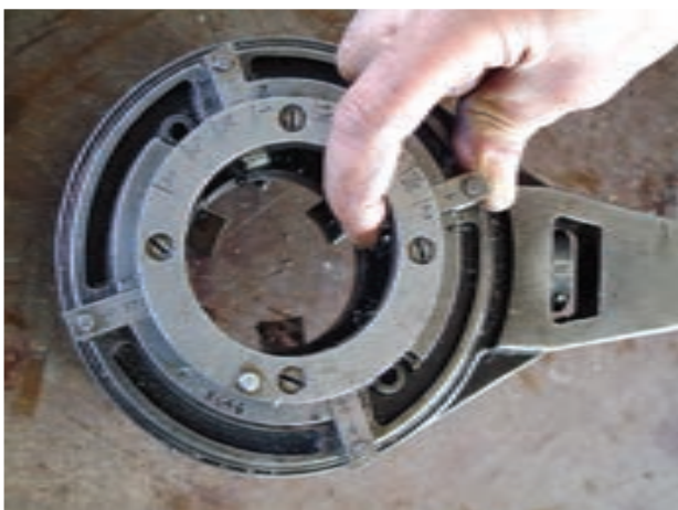
شکل ۴-۶۰- قرار دادن پارچه‌های مناسب در حدیده
