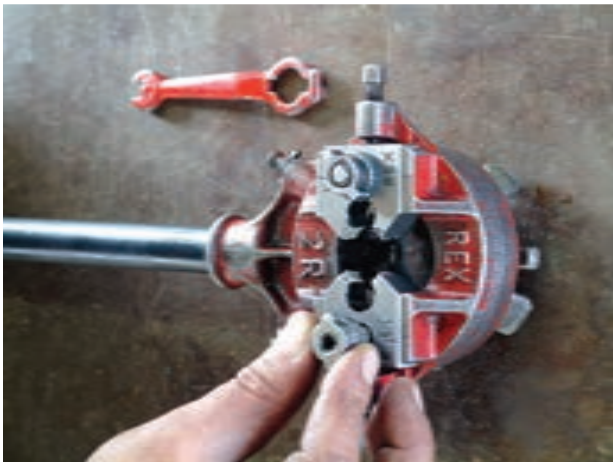
شکل ۴-۲۷ - بستن مهره‌ها بر روی پارچه‌های حدیده
