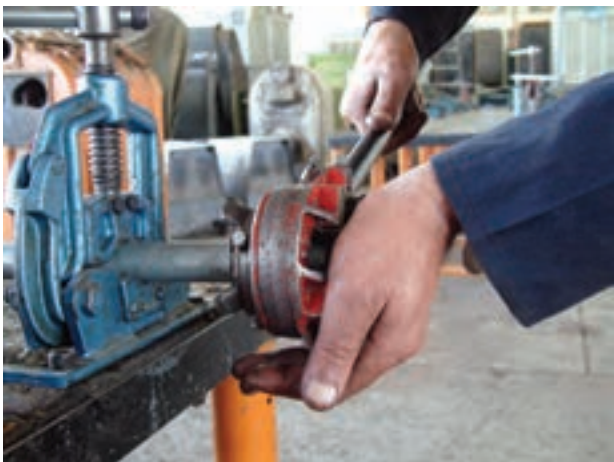
شکل ۳۳-۴- درگیر نمودن پارچه‌های حدیده با لوله
