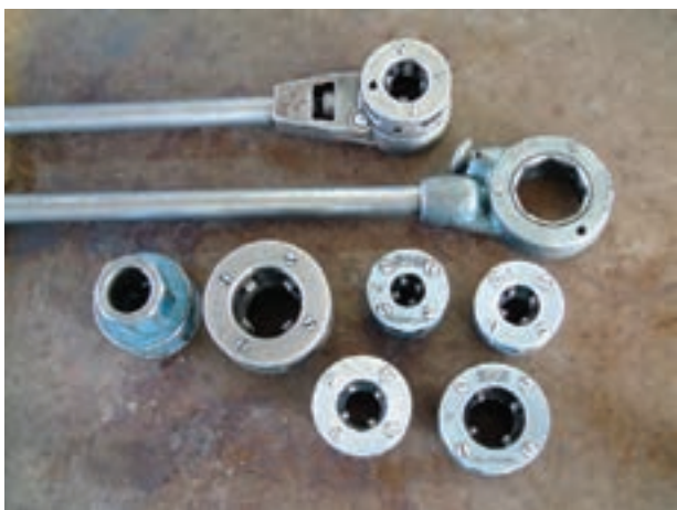
شکل ۴-۴۲- حدیده‌ی چهارپارچه‌ی غیرقابل تنظیم
