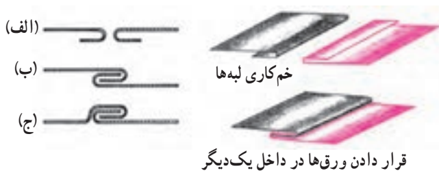
شکل ۴-۲- مراحل مختلف اتصال پیچک
