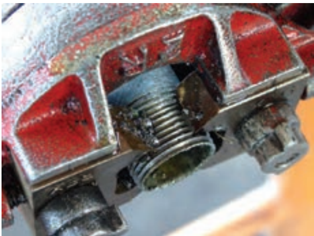
شکل ۴-۳۶- عبور دو دندانه از انتهای پارچه
