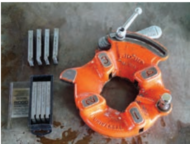
شکل ۸۸-۴- تنه‌ی حدیده و پارچه‌های آن
