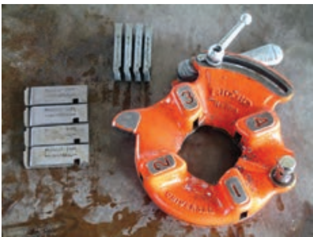
شکل ۸۹-۴- مشخصات حک شده بر روی پارچه‌های حدیده
