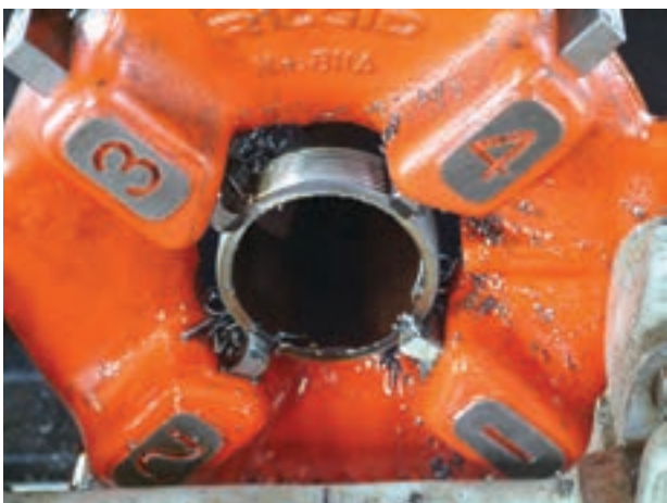
شکل ۴-۸۰- لوله در حال باز شدن از پارچه‌ها
