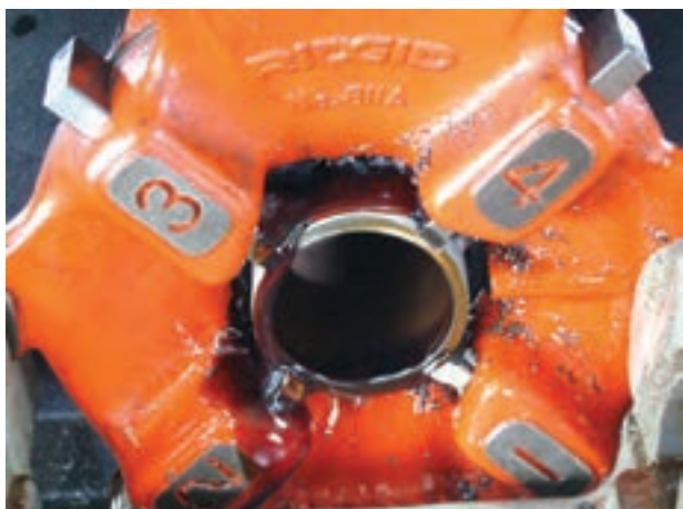
شکل ۴-۹۵- عمل حدیده‌کاری به وسیله حدیده‌ی ماشینی
