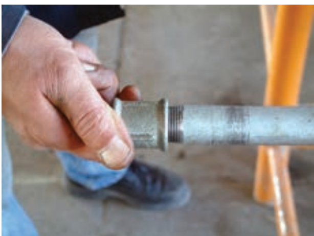
شکل ۴-۴۱- کنترل بار سردنده به وسیله‌ی یک فیتینگ
