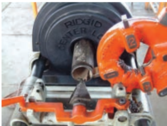
شکل ۴-۱۰۲- شروع عمل بُرقوکاری
