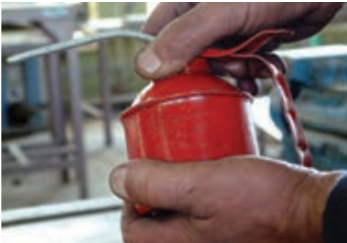
الف - باز کردن پمپ از مخزن روغن
