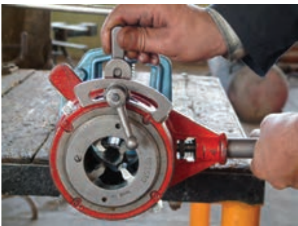
شکل ۱۲۵-۴- كم كردن بار پارچه‌هاي حديدك
