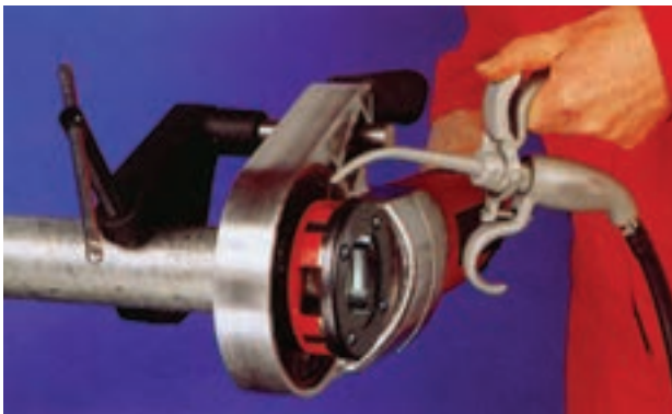
شکل ۴-۱۰۸- استفاده از روغن‌دان در جریان لوله‌کشی
