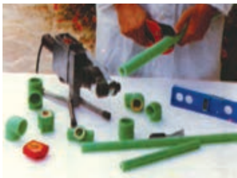
شکل ۵-۲۷- بریدن لوله به وسیله‌ی قیچی مخصوص
