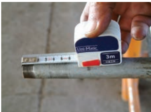
شکل ۱۲۸-۴- اندازه‌گیری لوله‌ی حدیده شده
