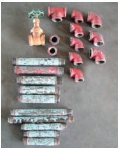
شکل ۱۳۱-۵- حدیده کردن همه‌ی لوله‌ها و آماده کردن شیرفلکه و فیتینگ‌ها
