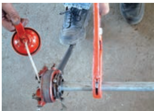
شکل ۱۲۱-۵- استفاده از روغن در جریان حدیده کاری
