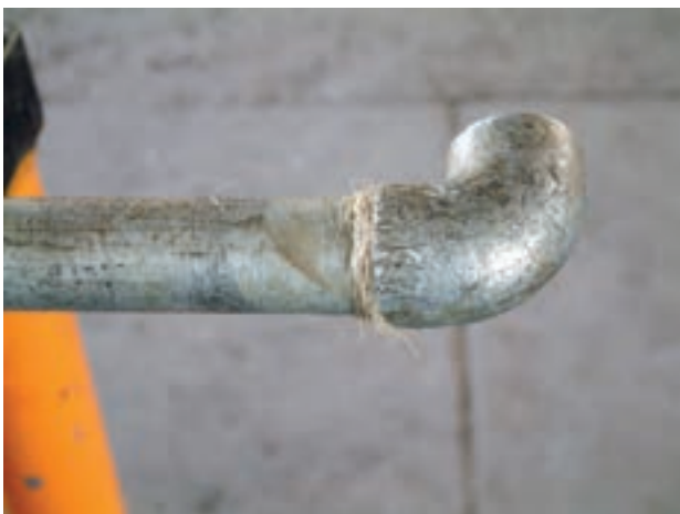
شکل ۹۸-۵- فیتینگ بدون لبه
