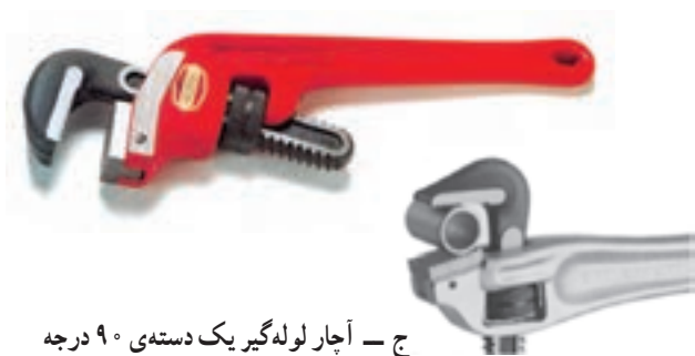
شکل ۵-۶۳ - انواع آچار لوله‌گیر یک دسته
