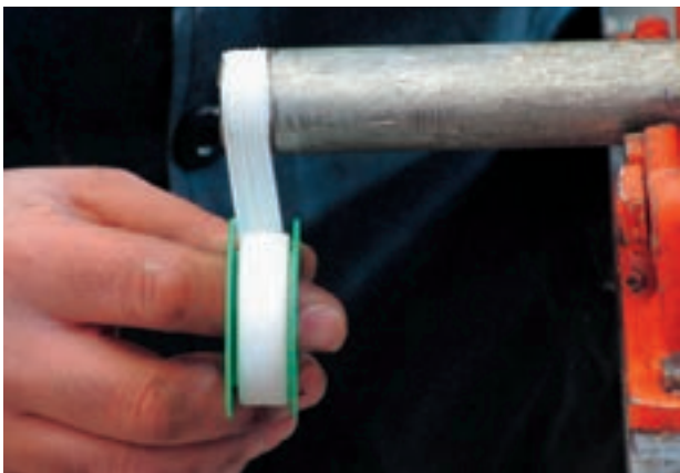
شکل ۵-۵۸- نحوه‌ی پیچیدن نوار تفلون بر روی سردنده
