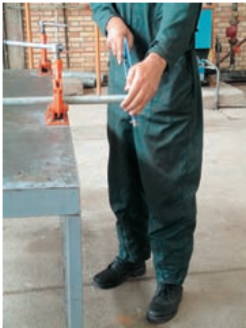
شکل ۵-۹۵- فاصله‌ی محل برش از لبه‌ی گیره‌ی لوله بیش از حد مجاز است.
