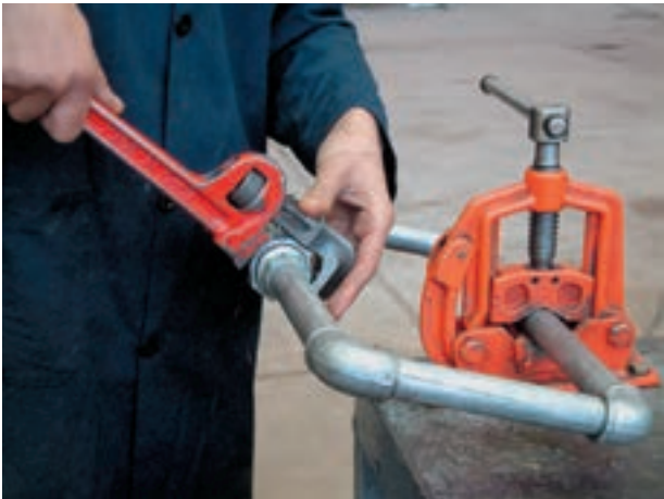
شکل ۵-۱۰۶- نحوه‌ی غلط سفت کردن مهره ماسوره
