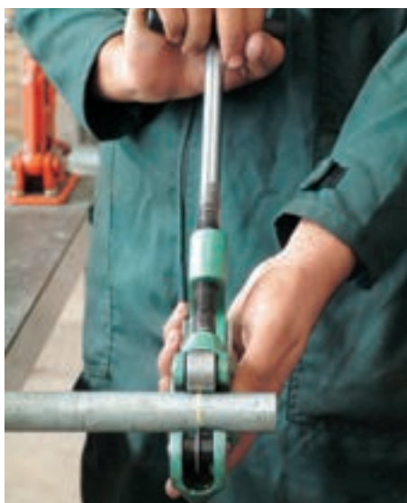
شکل ۱۳۵-۵- بریدن لوله‌های مورد نیاز
