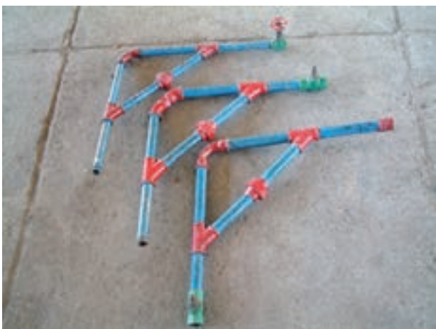
شکل ۱۴۷-۵- اجرای مدار مطابق نقشه به سه شکل متفاوت با استفاده از فیتینگ‌های مختلف
