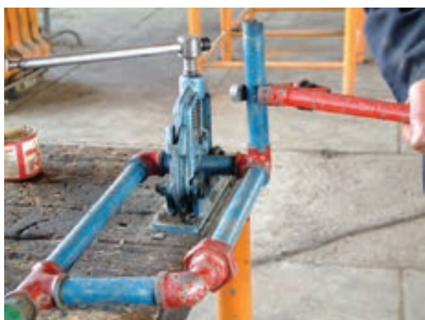
شکل ۱۶۲-۵- بستن لوله‌ی عمود بر مدار بر روی سده‌راهی کنج
