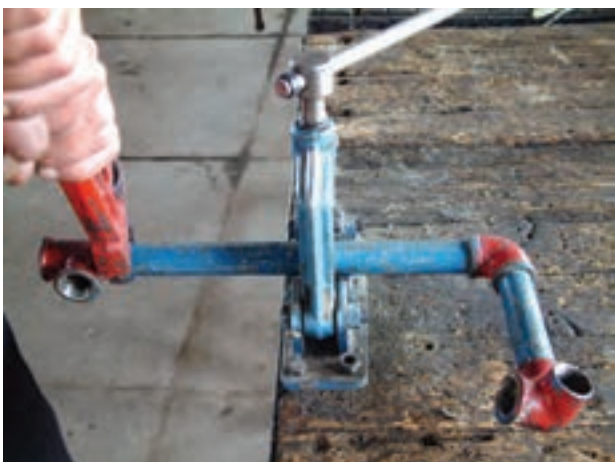
شکل ۵-۱۵۵- بستن سه‌راهی به ضلع دوم مدار
