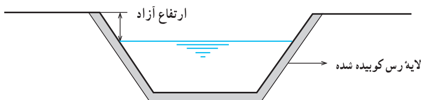
شکل ۱۶-۲- مقطع یک کانال با پوشش خاک رس
