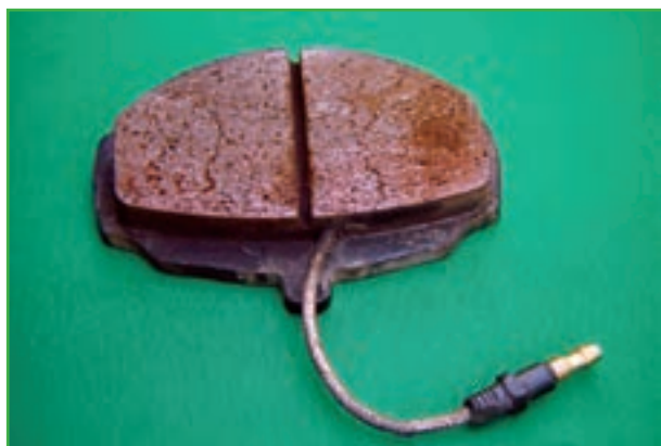
شکل ۱۱۲-۱- لنت ترمز دارای سیم هشدار
