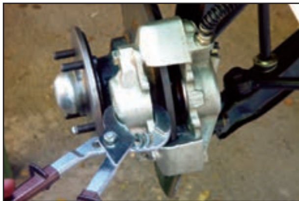
شکل ۱۱۴-۱- عقب راندن پیستون ترمز دیسکی
