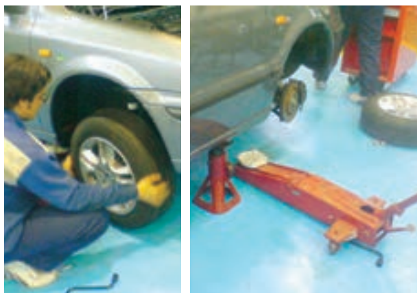
شکل ۱-۱۱۷- بالا بردن و پیاده کردن چرخ جلو
