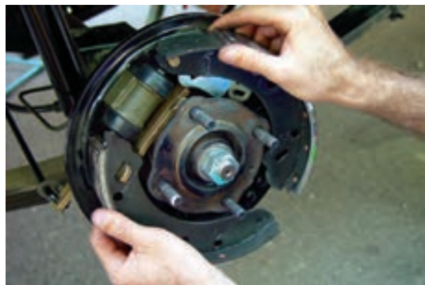
شکل ۹۳-۱- خارج کردن کفشک‌ها
