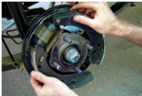
شکل ۱۰۴-۱- خارج کردن کفشک‌ها
