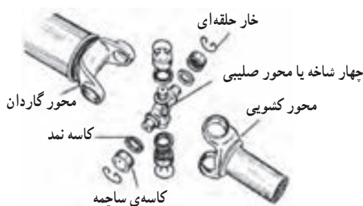
شکل ۲۹۱- اجزای قفل‌گاردان
