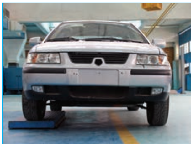
شکل ۱۹-۳ مزایای سیستم تعلیق مستقل
