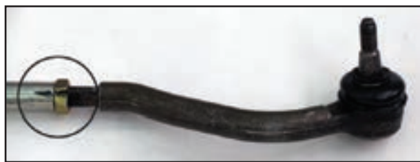
شکل ۲-۷۴- علامت گذاری سیبک و میل رابط
