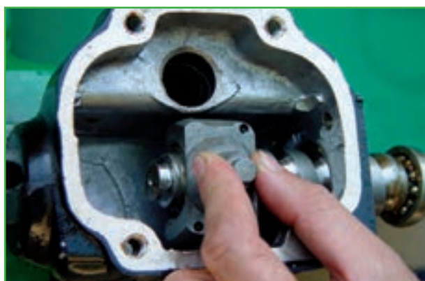
شکل ۲-۶۳ خارج کردن محفظه ساچمه‌ها
