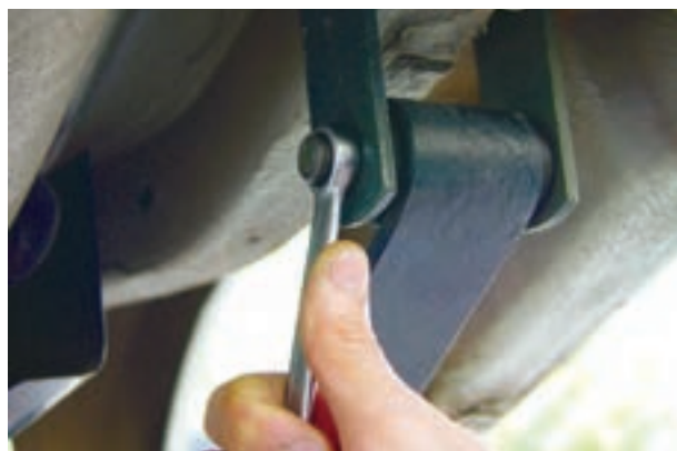
شکل ۳-۶۵ – باز کردن مهره‌های گوشواره فنر شمش
