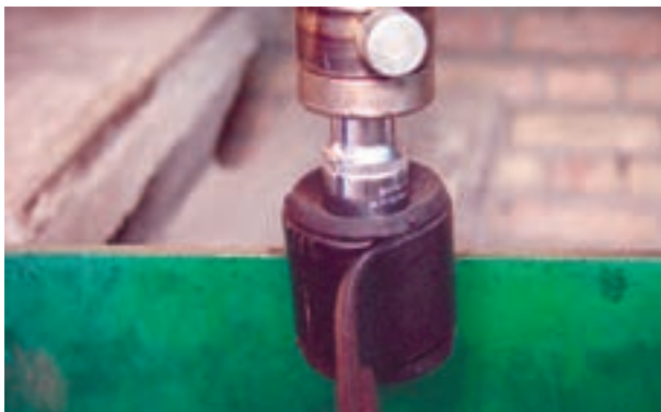
شکل ۳-۶۹- بوش لاستیکی فلزی محل اتصال شاه فنر
