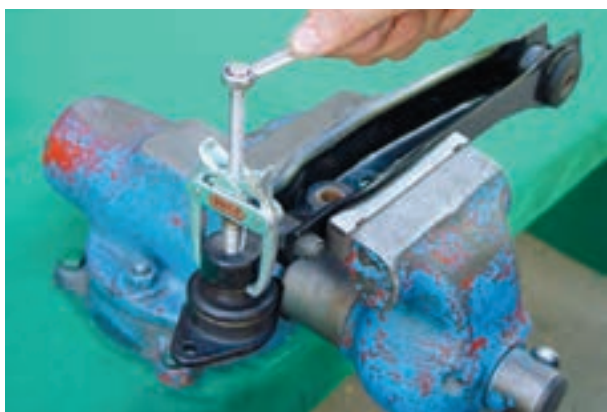
شکل ۳-۸۵- جدا کردن سیبک از بازوی اتصال
