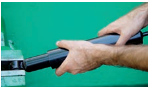
شکل ۳-۷۴- آزمایش کمک فنر
