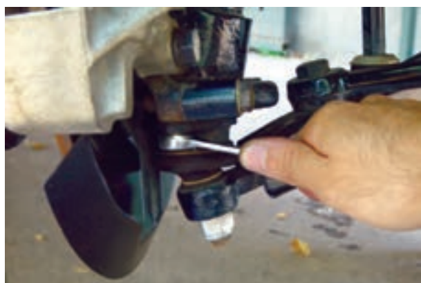
شکل ۳-۷۸- باز کردن سبک زیر کمک فنر
