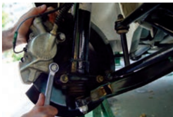
شکل ۳-۷۷- باز کردن کالیبر ترمز
