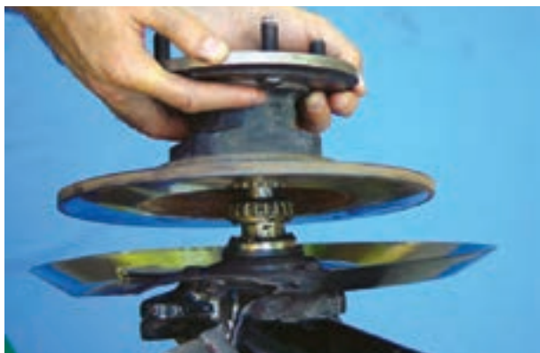
شکل ۳-۹۴- خارج کردن دیسک ترمز و توپی از روی محور چرخ
