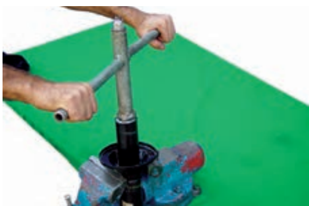
شکل ۳-۹۱- باز کردن مهره نگه‌دارنده کمک فنر
