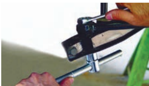
شکل ۳-۸۱ باز کردن میل تعادل از طبق
