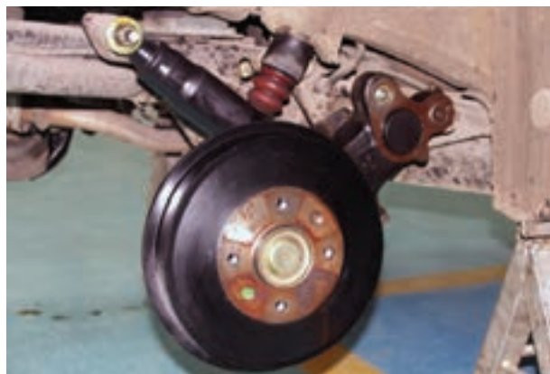
شکل ۱۷۷-۳- نصب کمک فنر
