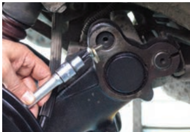
شکل ۱۷۶-۳- نصب واشر فشار و بیج‌های انتهایی میله‌ها
