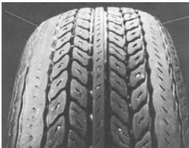
شکل ۲۱۴-۳- سایش در اثر رانندگی غلط (پیچیدن تند)
