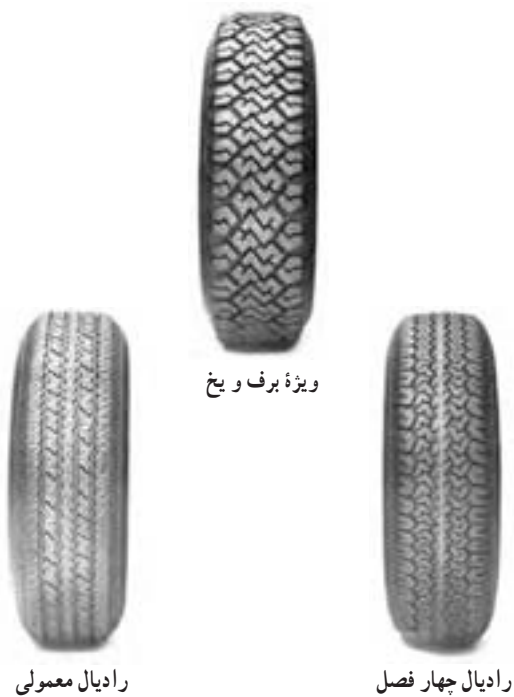
شکل ۲۱۲-۳- چند نوع آج لاستیک
