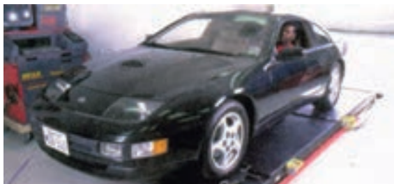
شکل ۳-۲۱۹- دستگاه اندازه‌گیری زوایای رایانه‌ای (کامپیوتری)
