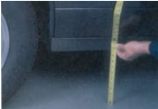
شکل ۳-۲۰۱- ارتفاع سیستم تعلیق (خودرو)
