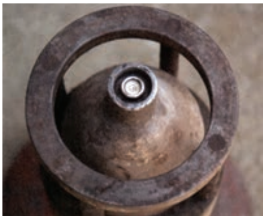
شکل ۳-۲۳۰- دستگاه بالانس حباب‌دار
