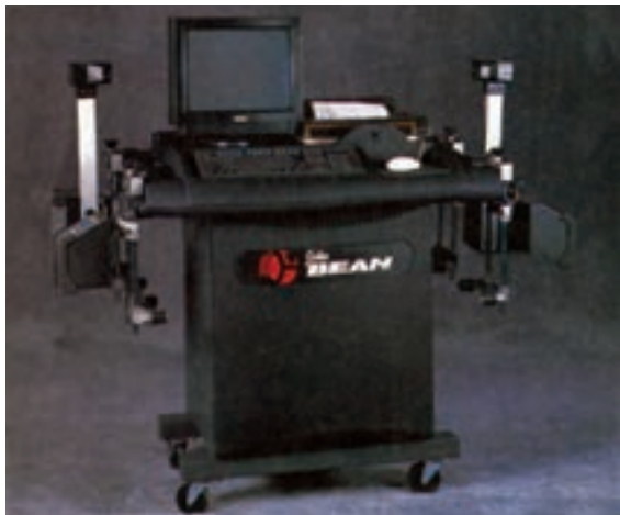
شکل ۳-۲۱۸- دستگاه اندازه‌گیری زوایای نوری
