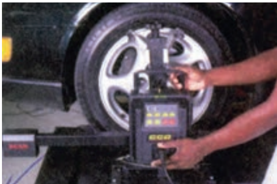
شکل ۳-۲۲۰- نصب مجموعه حسگر دستگاه اندازه‌گیر رایانه‌ای
