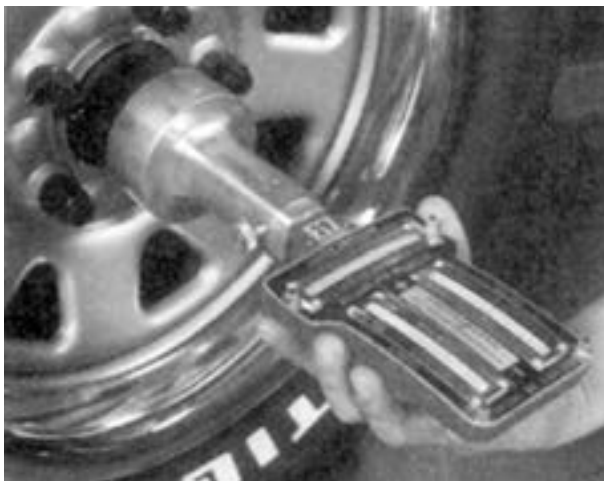
شکل ۲۱۷-۳- دستگاه اندازه‌گیری زوایای مکانیکی (ترازی)
