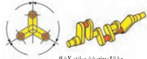
میل لنگ موتور شش سیلندر V شکل
