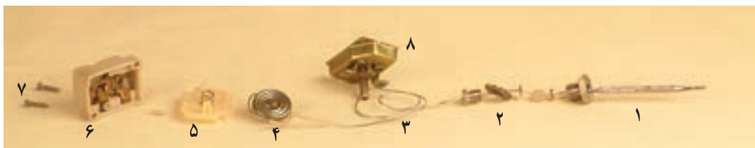
شکل ۱۰-۲ اجزای ترموستات گازی
