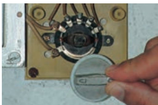
شکل ۷-۳۷۶ سیم رابط فاز خروجی کلید به پنکه
