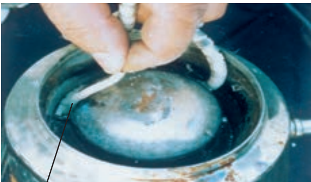
شکل ۲-۲۱ محلی که عایق‌بندی ضعیف است
