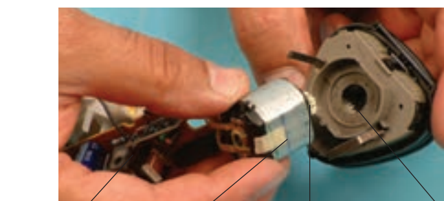
چرخ دنده‌های جعبه دنده، چرخ دنده‌های سرموتور، موتور DC، مدار شارژ و منبع تغذیه
