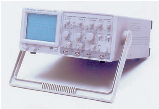
شکل ۲-۳۰ دستگاه اسیلوسکوپ
