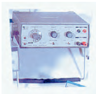
شکل ۳-۳۱- دستگاه سیگنال ژنراتور AF
