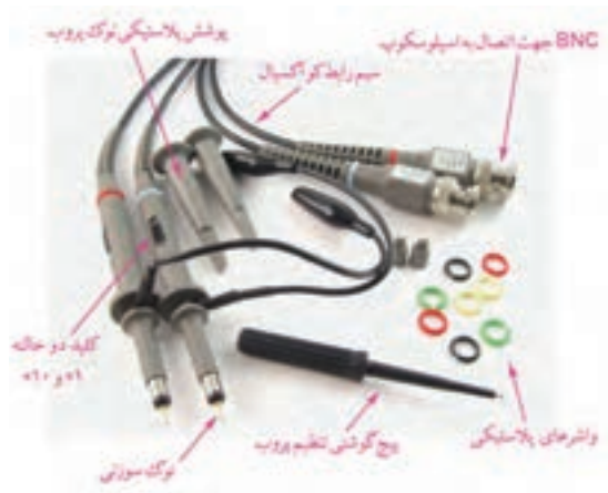
شکل ۵-۶ پروب و اجزای آن
