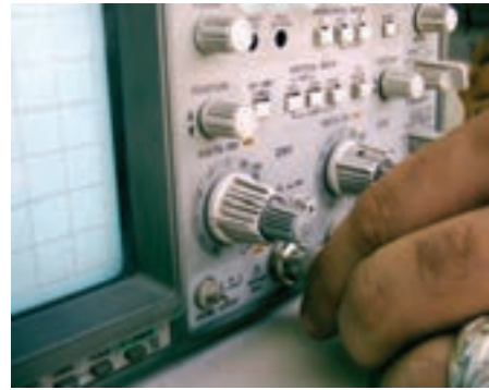
شکل ۶-۶ نحوه‌ی اتصال BNC به اسیلوسکوپ
