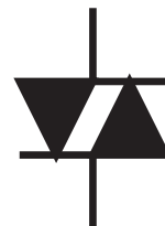
شکل ۹-۱۱ شکل ظاهری، ساختمان داخلی و علامت قراردادی دایاک
