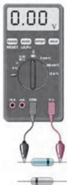
شکل ۱۰-۳۵ تست دیود معیوب (اتصال کوتاه)
