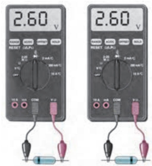
شکل ۱۰-۳۴ تست دیود معیوب (قطع)
