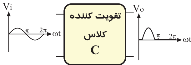
شکل ۳-۶ تقویت کننده کلاس C
