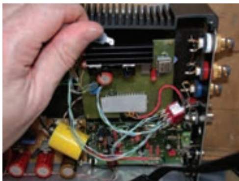
شکل ۷-۱۴ محل نصب هیت سینک
