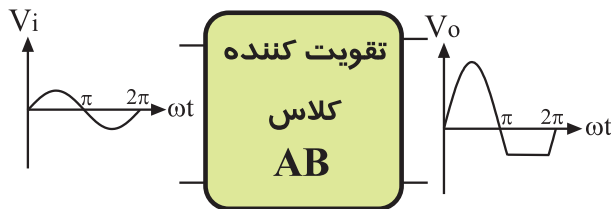
شکل ۳-۵ تقویت کننده کلاس AB
