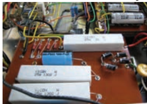
شکل ۷-۱ فیبر مدار چاپی به روش قدیمی
