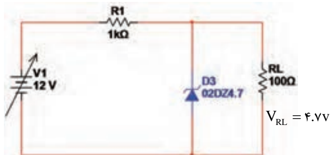
شکل ۴۹-۱- مدار رگولاتور ولتاژ با دیود زنر
