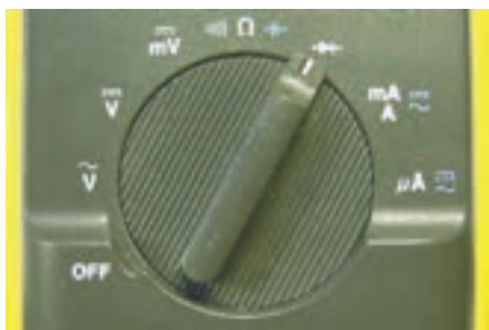
شکل ۱۷-۱- وضعیت آزمایش دیود با مولتی‌متر دیجیتالی
