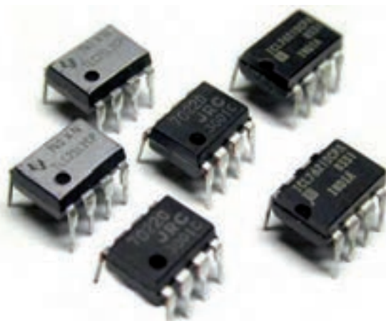
شکل ۴-۵۶- چند نمونه آی سی دروازه منطقی
