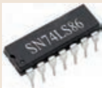
شکل ۴-۷۱ یک IC از نوع TTL
