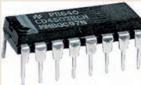
شکل ۴-۷۵ یک نمونه آی سی CMOS
