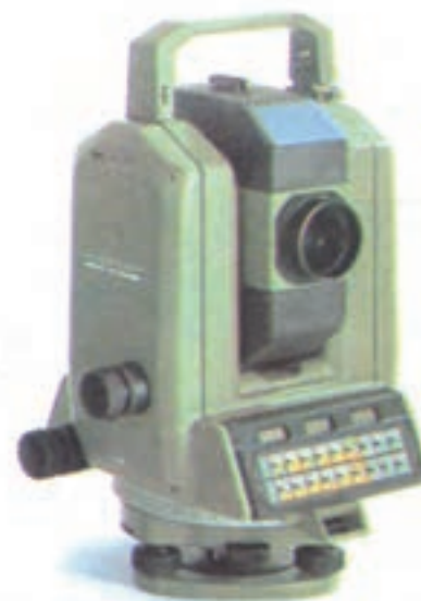
شکل ۲۴-۴ فاصله‌یاب در داخل دوربین نقشه‌برداری
