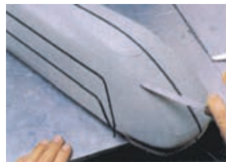
۸- با قرار دادن یک صفحه رنگی، پنجره‌های مدل ساخته شده است.
