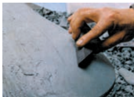
۴- سطح مدل را با یک لیسه پلاستیکی نرم صاف کنید.
