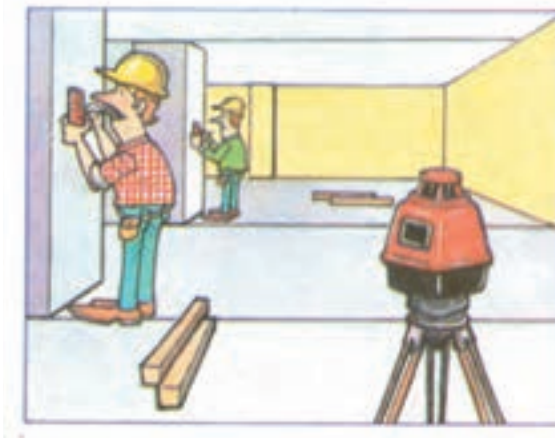
شکل ۴۸-۸- کاربرد تراز یابی «خط تراز در ساختمان»
