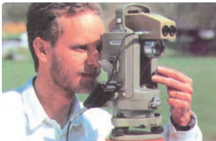
شکل ۲۳-۴ نصب فاصله‌یاب روی دوربین
