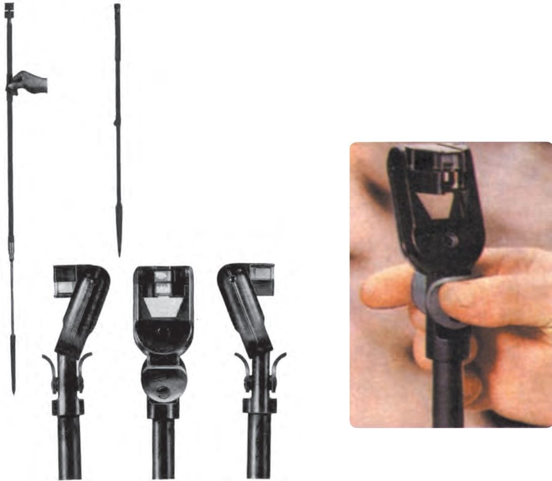
شکل ۸-۳- گونیای منشوری و پایه‌ی مخصوص آن
