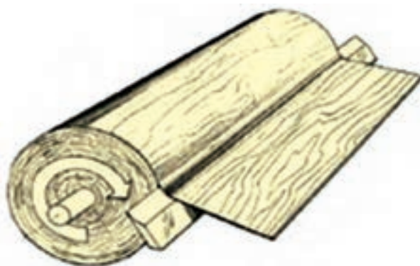
شکل ۱-۲۰ تهیه روکش به روش لوله‌بری
