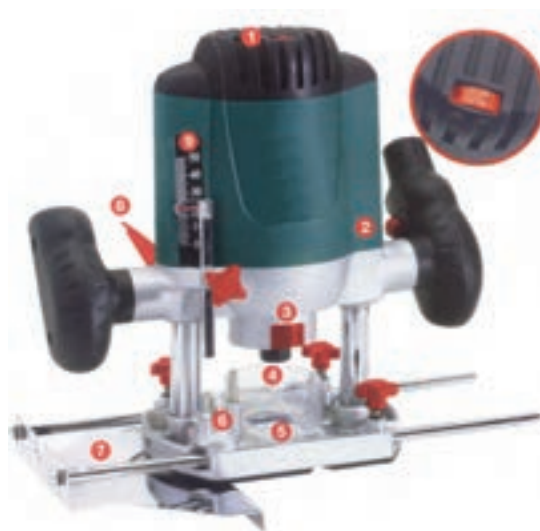
شکل ۲-۳۹ قسمت‌های مختلف ماشین اور فرز دستی برقی
