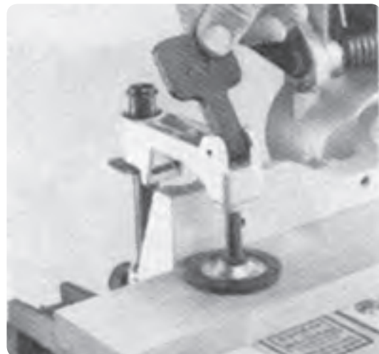
شکل ۲-۱۱- بستن قطعه کار با گیره
