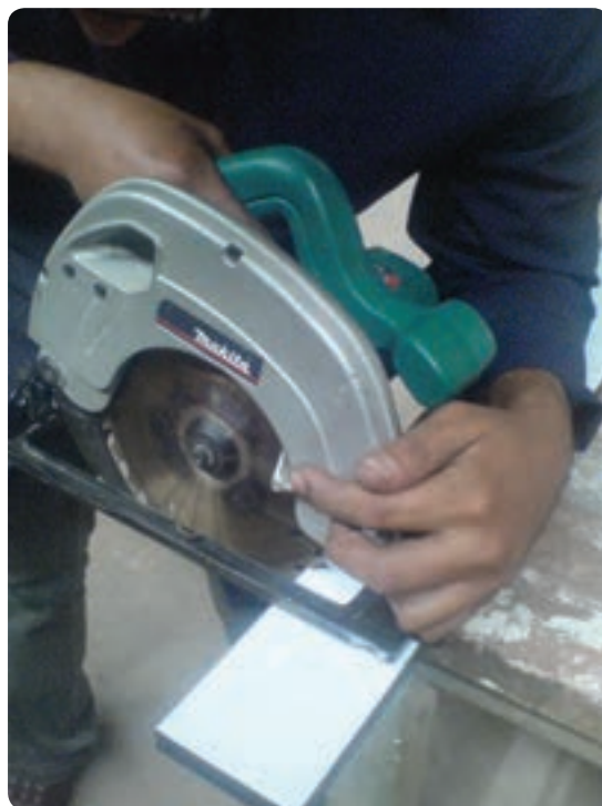
شکل ۲-۲۸ بیانگر رعایت نکردن اصول ایمنی در برش قطعه کار بدون بکارگیری گونیا یا بر راستی است
