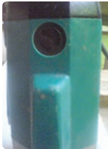
شکل ۶۷-۲ محفظه قرارگیری زغال کلکتور
