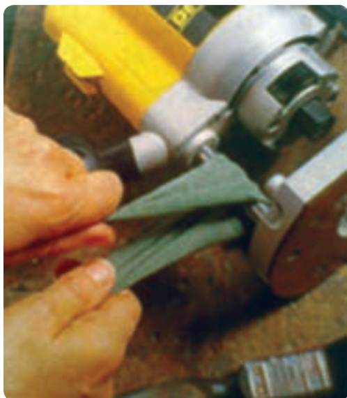
شکل ۲-۶۶ تمیز کردن میله‌های کنسویی اورفرز
