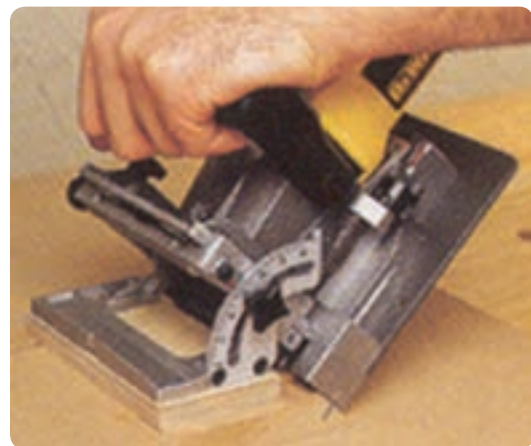
شکل ۲-۹۰ شیارزنی با زاویه ۴۵ درجه
