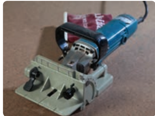
شکل ۲-۹۳ کیسه جمع آوری خاک اره در ماشین اتصال زن بیسکویتی
