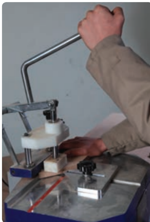
شکل ۲-۱۱۲ برش با زاویه ۴۵ درجه
