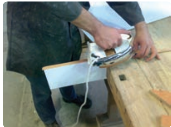
شکل ۱۴۷-۲ اتوکشی نوار روکش لبه چسبان
