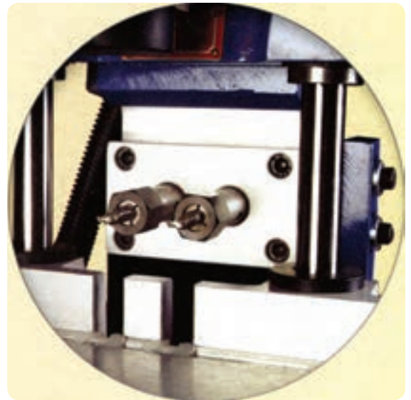
شکل ۱۰۹-۲ تیغه‌های ماشین دم چلچله زن
