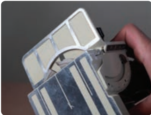
شکل ۲-۹۴ اتصال زن بیسکویتی بدون گونیا
