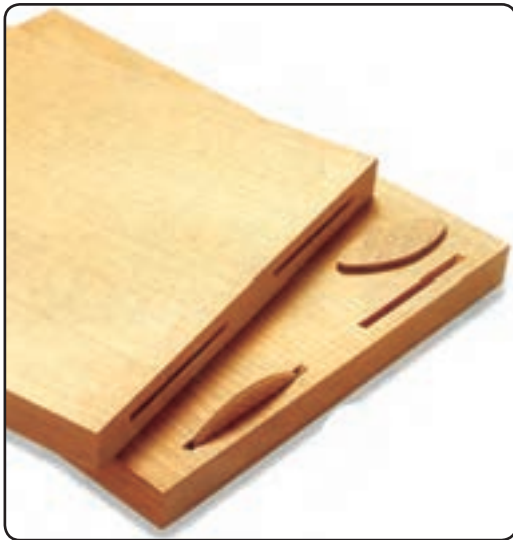
شکل ۸۲-۲ اتصال بیسکوییتی دوتایی
