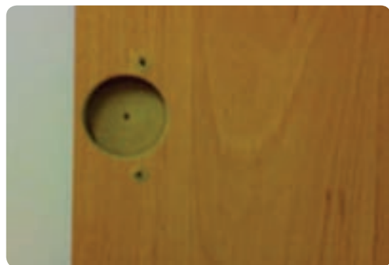
شکل ۶-۷۲ سوراخ‌کاری محل لولا و سوراخ محل پیچ لولا با دستگاه لولازن
