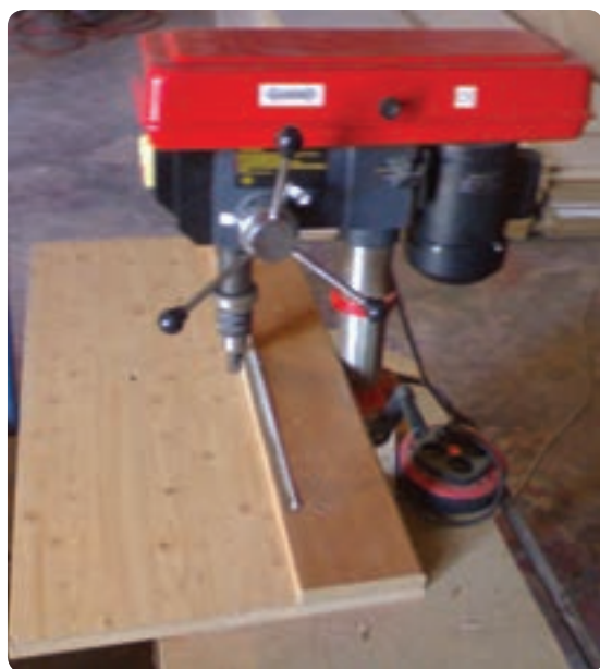
شکل ۶-۷۰- دریل ستونی همراه با شابلن جهت سوراخ‌کاری
