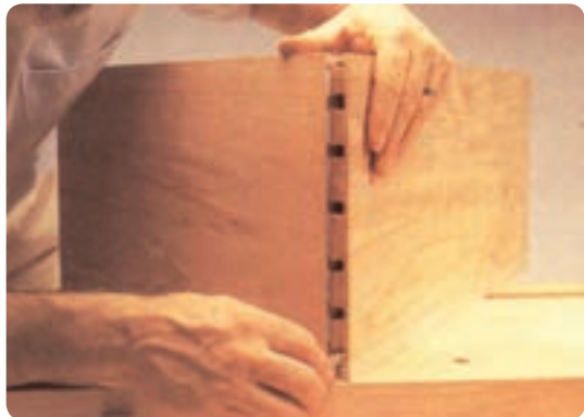
شکل ۶-۱۴۰ مونتاژ آزمایشی قبل از چسب زدن قطعات
