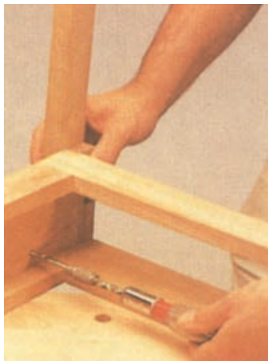
شکل ۶-۱۵۹ اتصال قاب دراور به قاب کناری
