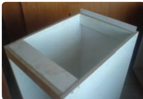
شکل ۶-۷۵ مونتاژ کابینت با قرارگیری پشت‌بند
