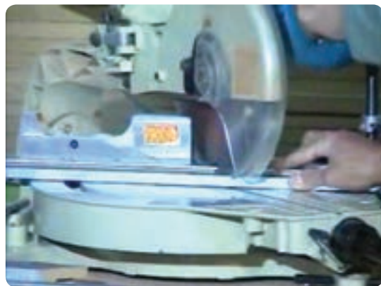
شکل ۹۲-۶ برش پروفیل‌ها با دستگاه فارسی بر
