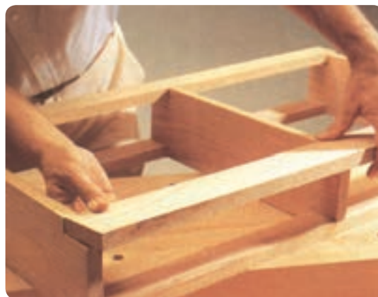
شکل ۶-۱۵۵ مونتاژ کلاف قاب دراور
