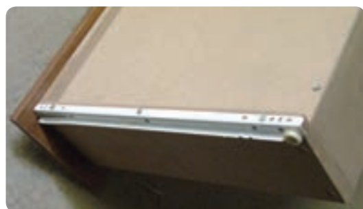
شکل ۶-۱۱۲ نصب ریل مکانیکی در زیر بدنه جعبه
