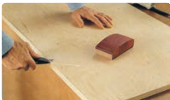
شکل ۸-۷۷ پرداخت لبه‌های اضافی روکش لبه‌چسبان
